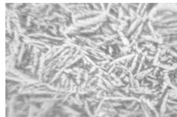
Микротвердость модифицированного материала составляет: светлая фаза  $H_{050} = 549-746$  кгс/мм<sup>2</sup>, темная фаза  $H_{050} = 500-524$  кгс/мм<sup>2</sup>
