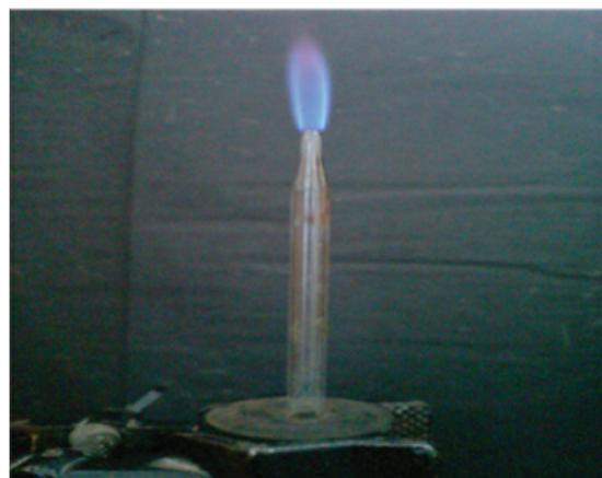
Горение биогаза, выделяющегося в процессе переработки отходов
