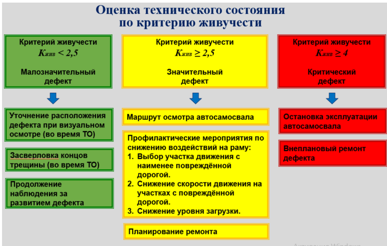
Рисунок 12 – Оценка технического состояния по критерию живучести
