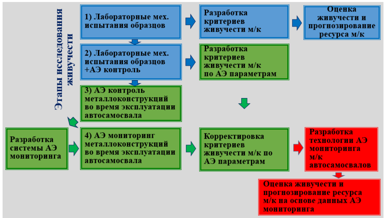
Рисунок 1 – Этапы разработки критериев живучести на основе АЭ метода (зелёным выделены блоки, разработанные с участием автора)
