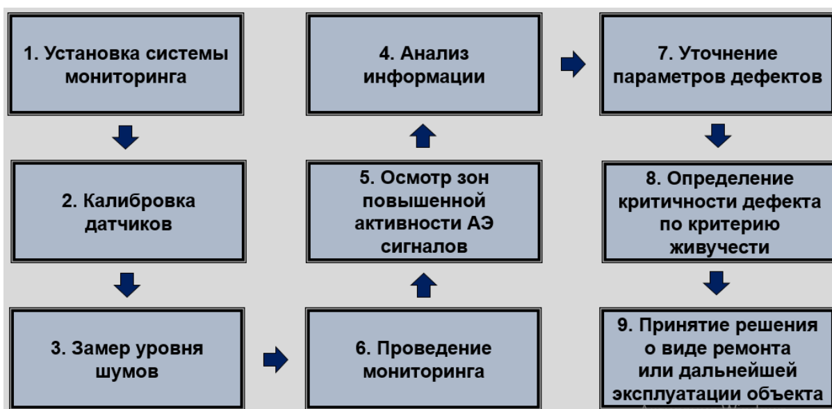
Рисунок 13 – Методика проведения АЭ мониторинга
