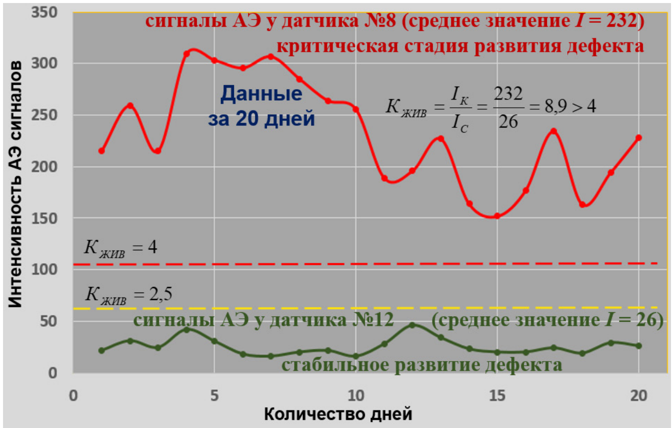
Рисунок 11 – Интенсивность АЭ сигналов за 20 дней (датчики № 8 и 12)
