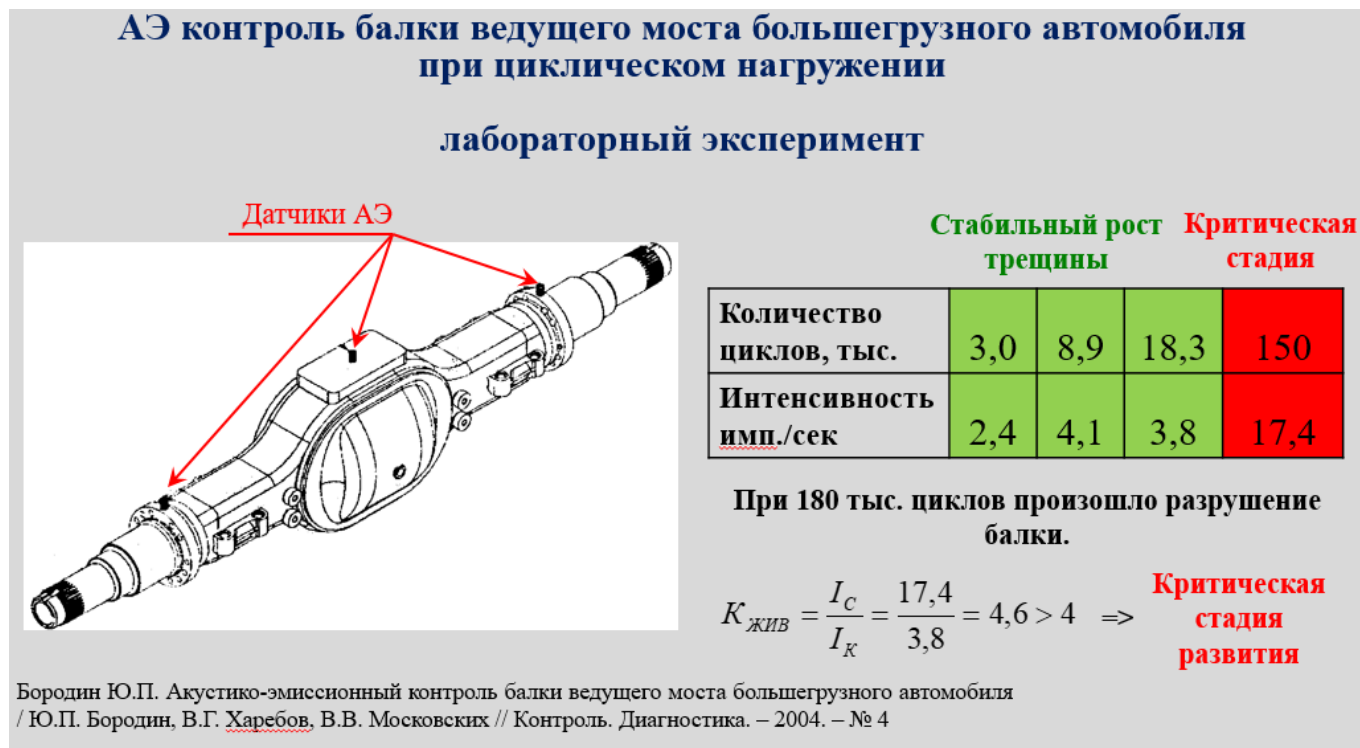
Рисунок 3 – АЭ контроль балки ведущего моста большегрузного автомобиля при циклическом нагружении
