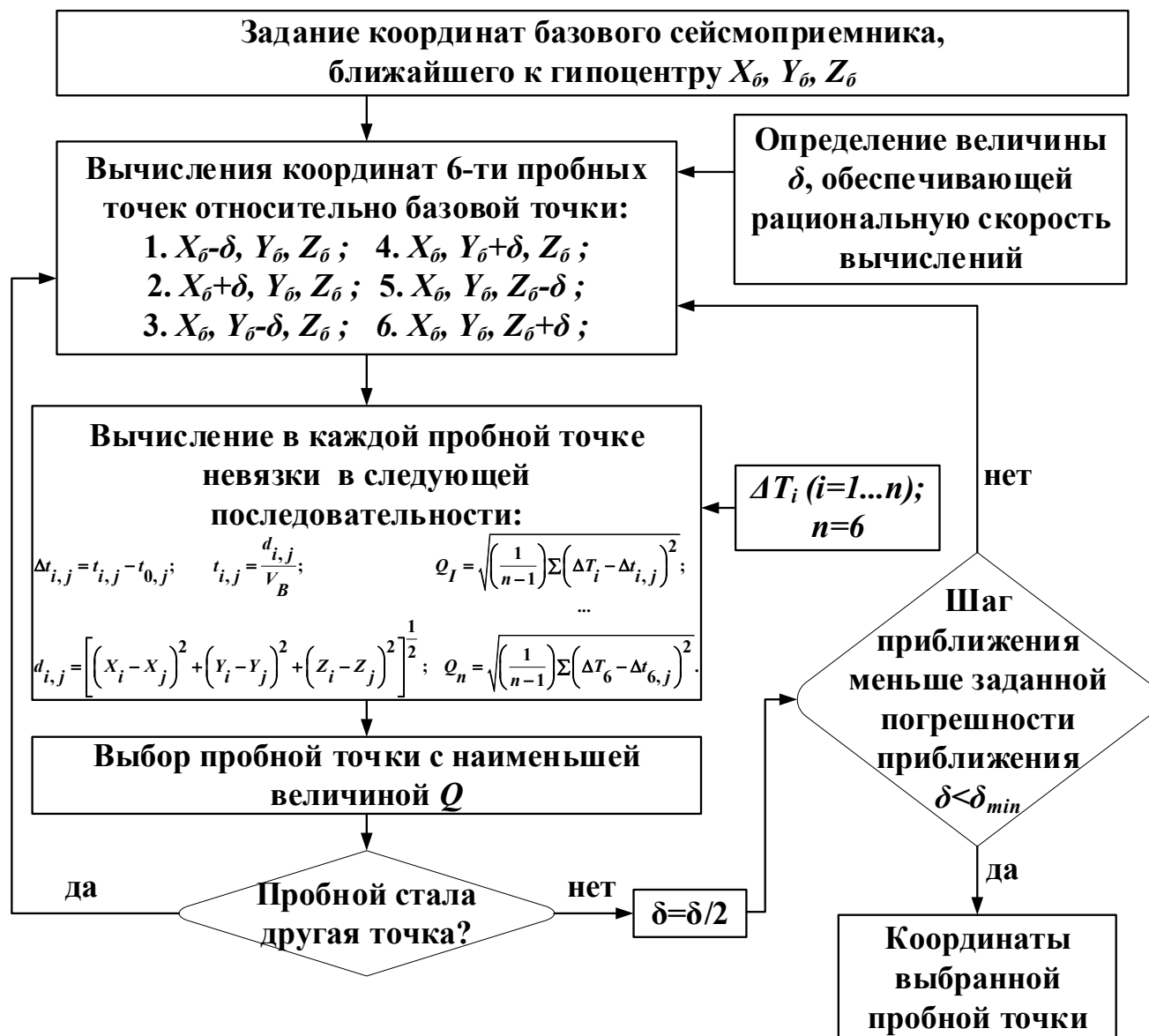
Рис. 1 – Алгоритм расчёта координат источника сейсмособытия методом SPAM: \delta – приращение координаты, рациональное по критерию времени счёта; \Delta t_{i,j} – задержка прихода сейсмволны от j -го вычисленного источника до i -го приёмника относительно прихода сейсмволны от того же источника до ближайшего к нему сейсмоприёмника; t_{i,j} – время прихода сейсмволны от j -го вычисленного источника до i -го приёмника; t_{0,j} – рассчитанное время прихода сейсмволны от j -го вычисленного источника до ближайшему к нему приёмника; d_{i,j} – рассчитанное расстояние между j -тым вычисленным источником и i -тым приёмником; X_i, Y_i, Z_i – координаты i -го приёмника; X_j, Y_j, Z_j – координаты j -го вычисленного источника; \Delta T_i – фактическая задержка прихода сейсмволны от источника до i -го приёмника относительно прихода сейсмволны от источника до ближайшего к нему сейсмоприёмника; n – количество сейсмоприёмников, n=6 ; Q_j – невязка для j -го вычисленного источника
