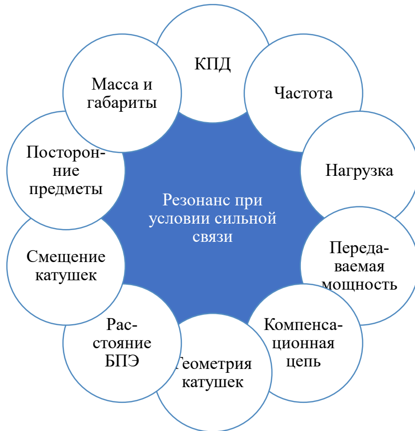
Рисунок 7 - Факторы, влияющие на эффективность системы беспроводного заряда
