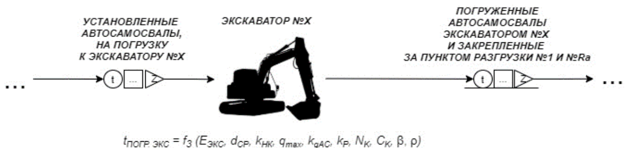
Рисунок 2.12 – Процесс погрузки горных пород в автосамосвалы экскаватором в виде СМО
