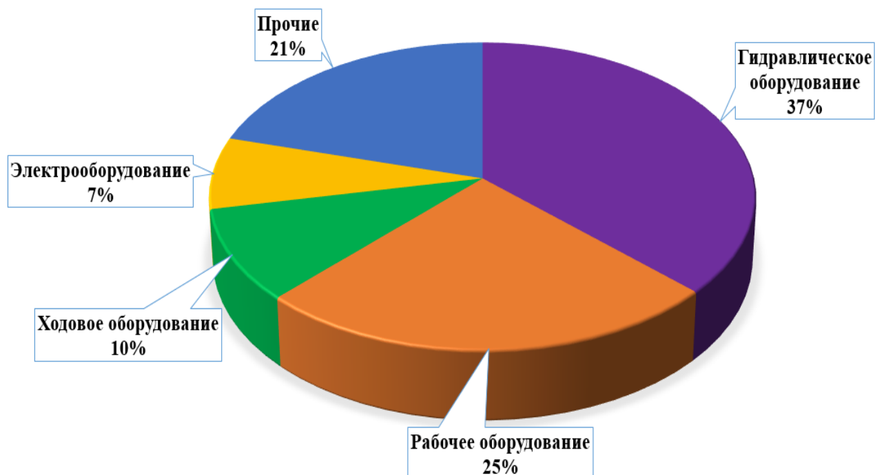
Рисунок 1.6 – Распределение технических (аварийных) простоев экскаваторов (П. Булес)
