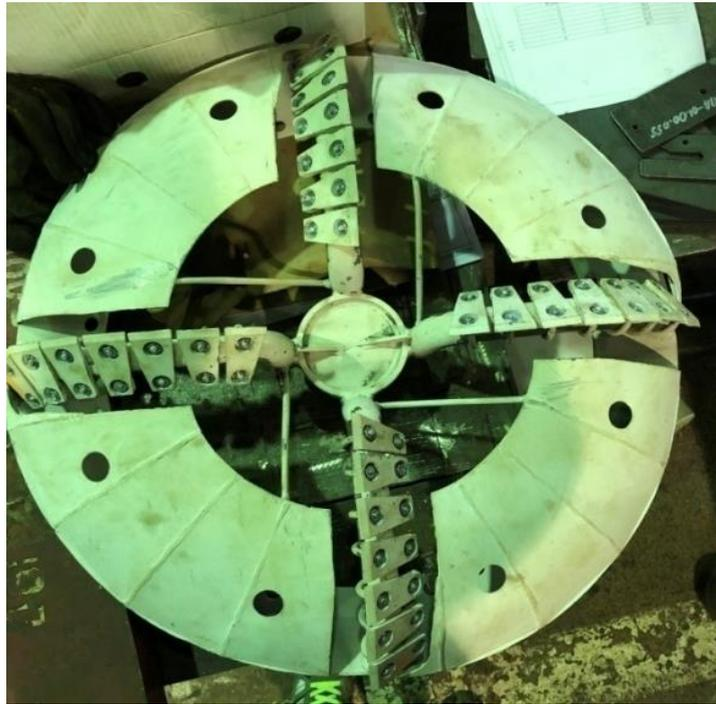
Рисунок 11 – Исполнительный орган демонстрационного образца геохода
