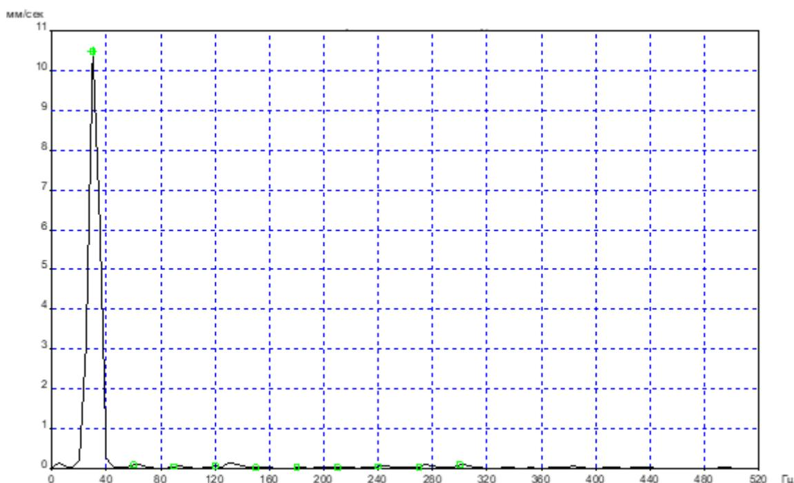
*Рисунок 4.30 – Спектр механических колебаний переднего подшипника первого насоса*
