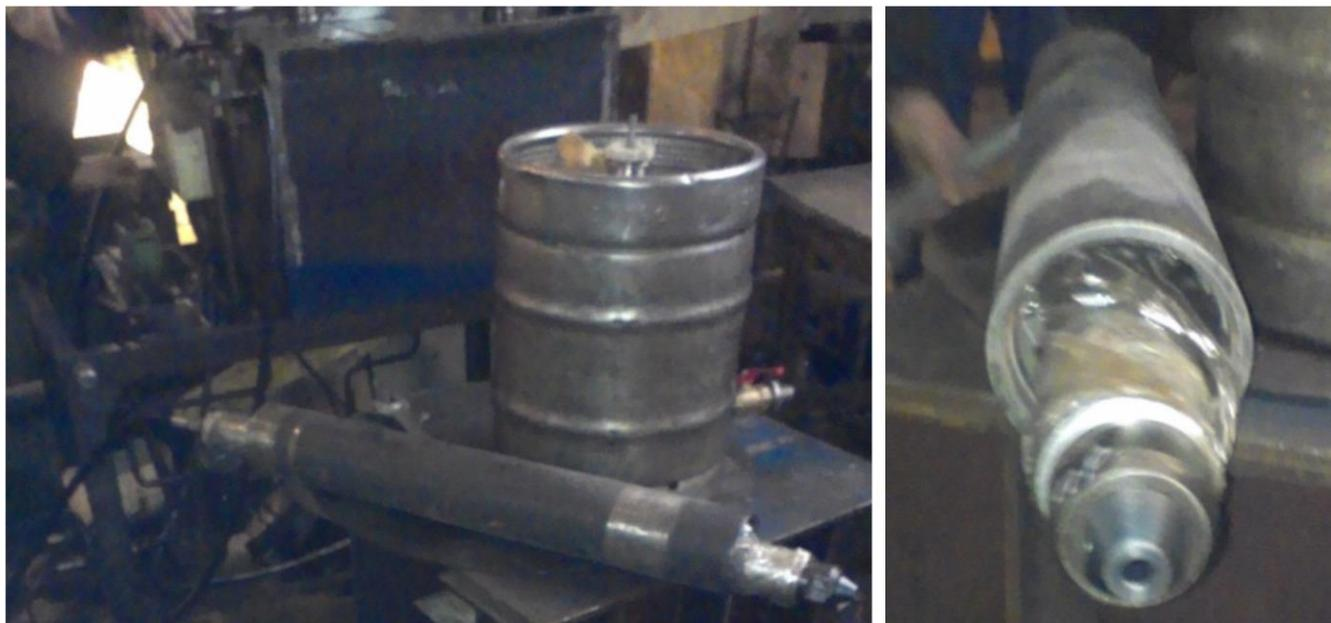
Рисунок 3.9 – Упруго расширяющийся рукав разрывного устройства и имитатор угольной скважины
