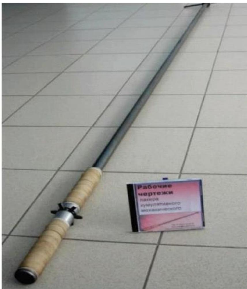
Рисунок 3.3 – Механический пакер с манжетными уплотнениями и концентраторами напряжений
