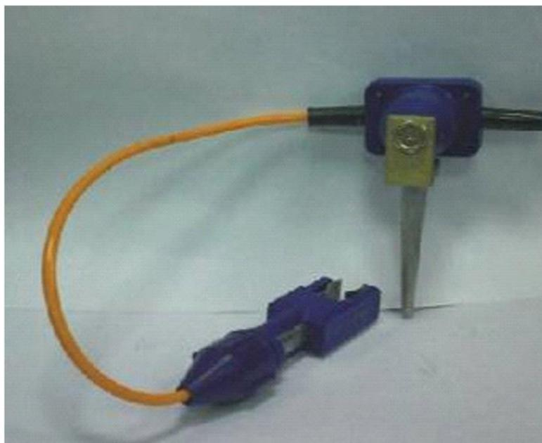
Рисунок 4.12 – Комплект шахтного оборудования для регистрации сейсмических данных: а) автономная сейсмическая станция «Р-1»; б) геофон GS-20DX
