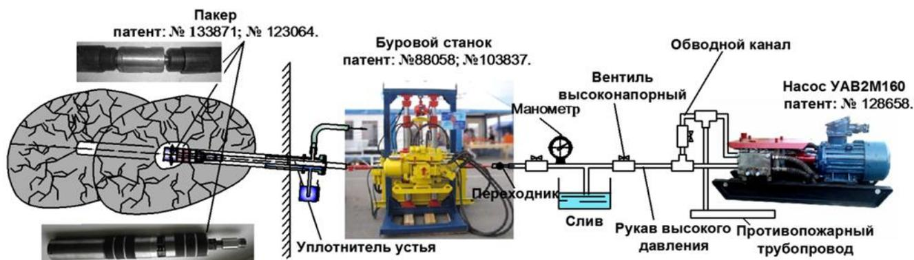
Рисунок 2.3 – Технологическая схема интенсификации дегазации метана поинтервальным гидроразрывом пласта через дегазационную скважину
