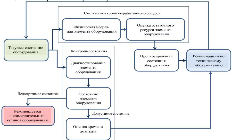
Рисунок 1 – Комбинированная структурная схема с блоками диагностирования и прогнозирования
