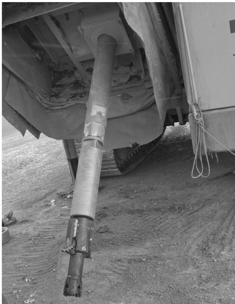
*Рисунок 4.8 – Экспериментальный шарошечный буровой инструмент, установленный на шарошечном станке DML1200*
