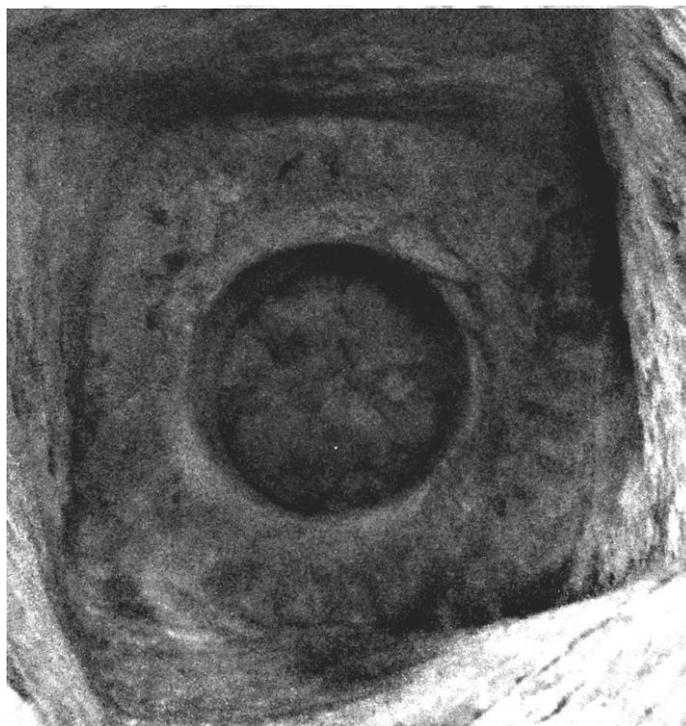
*Рисунок 4.11 – Полученная форма поперечного сечения скважины*
