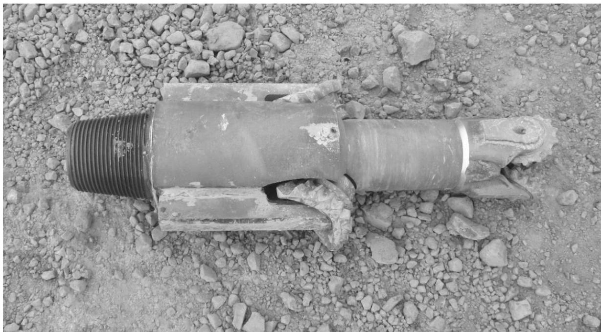
Рисунок 4.13 – Отработанный опытный шарошечный буровой инструмент
