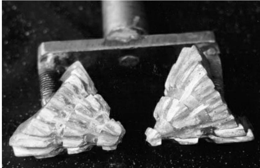
*Рисунок 2.16 – Макет двухшарошечного долота*
