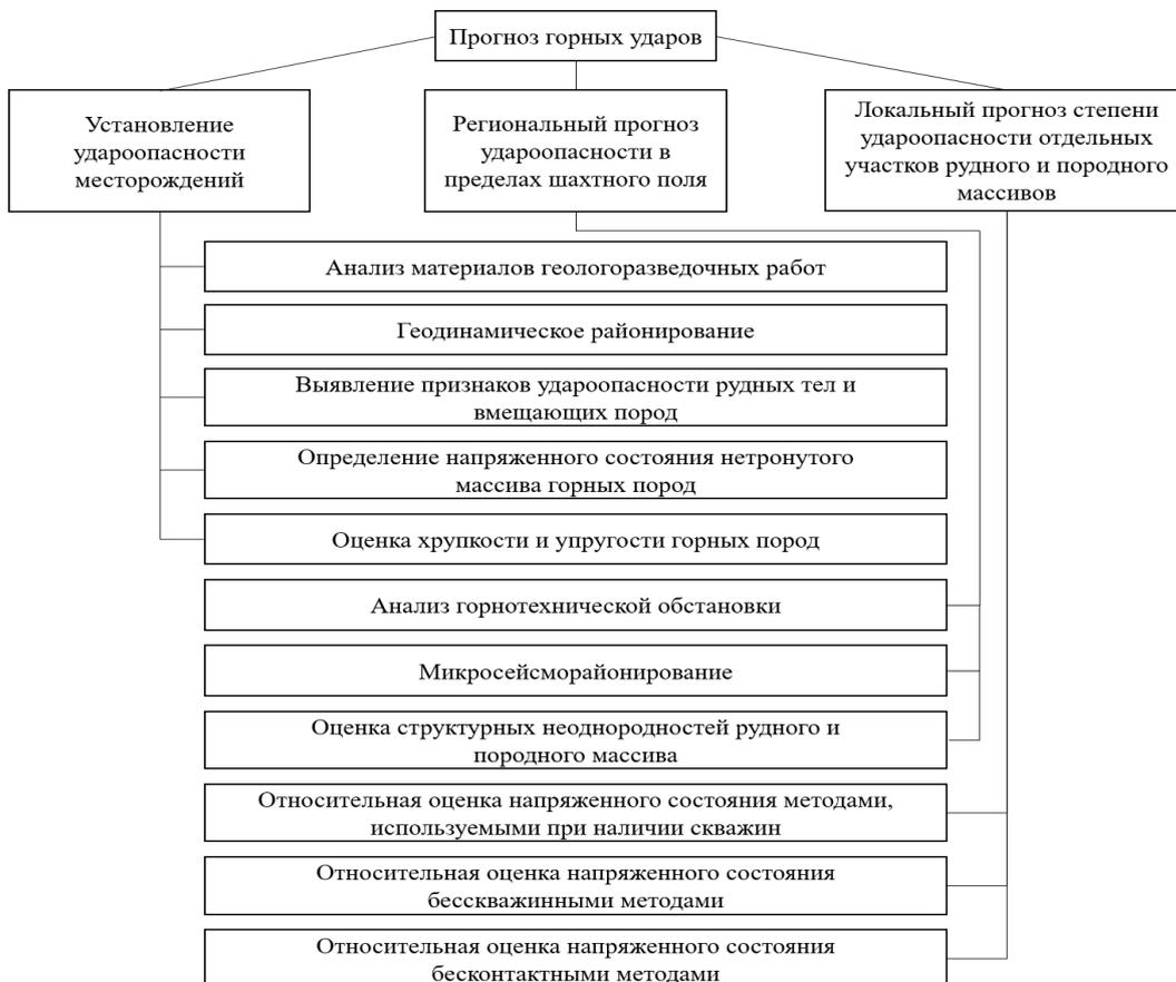
Рис. 1.10. Трехуровневая схема прогноза горных ударов на рудниках
