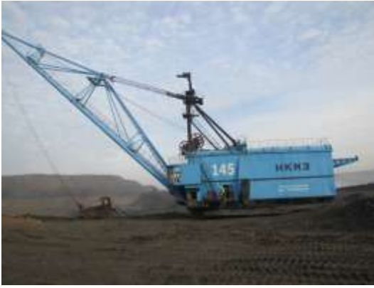
Общий вид шагающего экскаватора ЭШ13.50 (тип “драглайн”).
