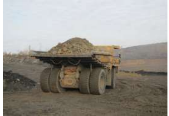
Фотофрагмент процесса перемещения вскрышной породы в автомобильный навал БелАЗом- 75131.
