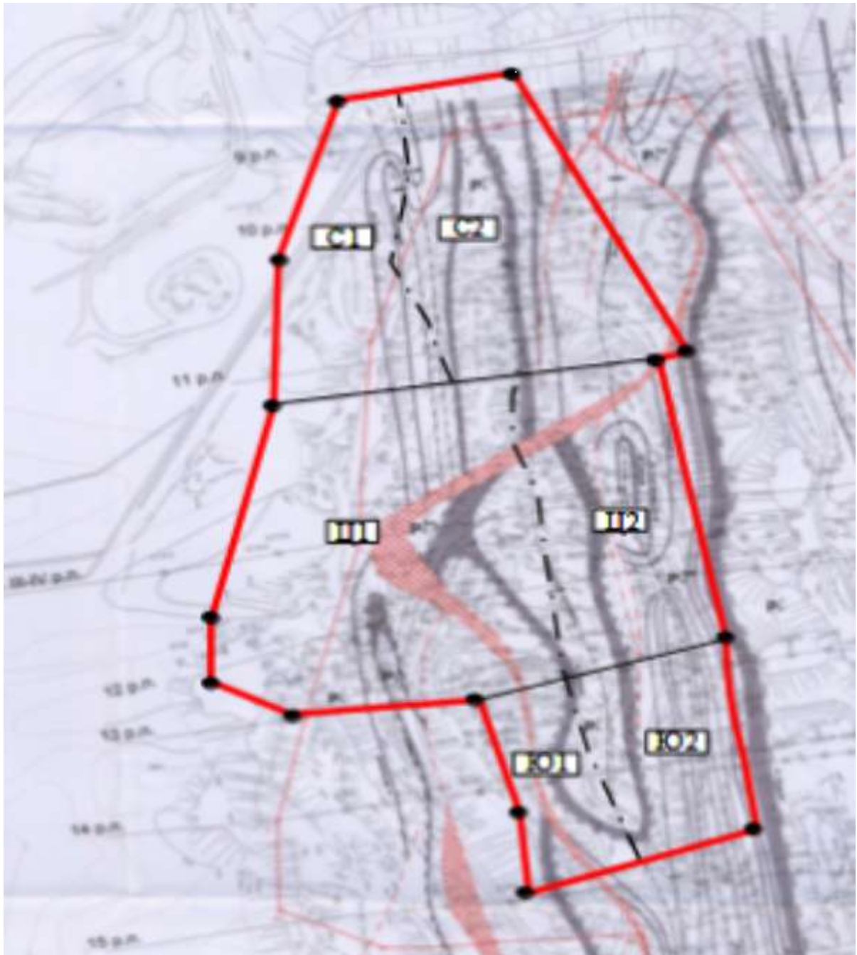
Рис. 2.5.1. Районирование карьерного пространства разреза «Прокопьевский» в плане на участки, при уточнении выбора местоположения емкости под внутренний отвал.
