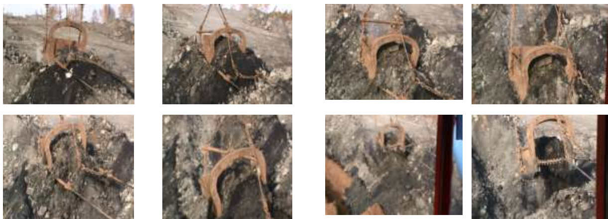
Рис.3.4.2. Покадровые фрагменты видеосъемки технологического процесса черпания вскрышных пород из автомобильного навала экскаватором типа ЭШ13.50, номер 145 (ЗАО “Стройсервис”).
