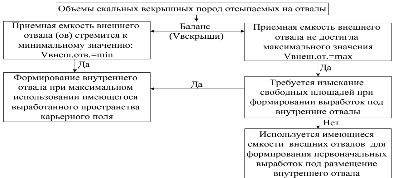
Рис. 2.5.3. Логическая блок-схема представления укрупненного баланса распределения вскрышных пород отсыпаемых на внешний или внутренний отвалы.
