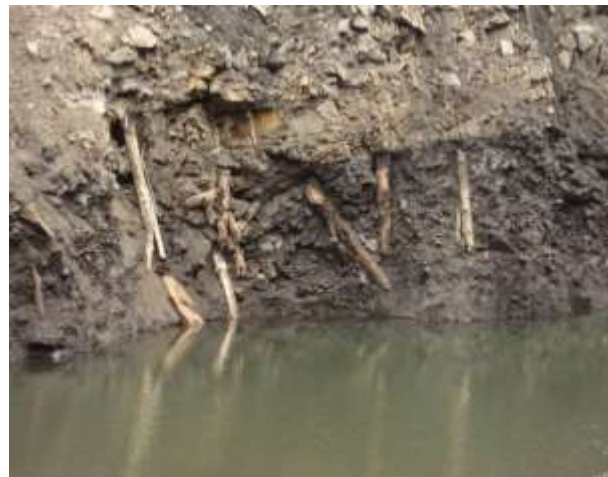
Пересечение фронтом открытых горных работ зон отработанных пластов подземным способом (разрез «Северный Маганак»)
