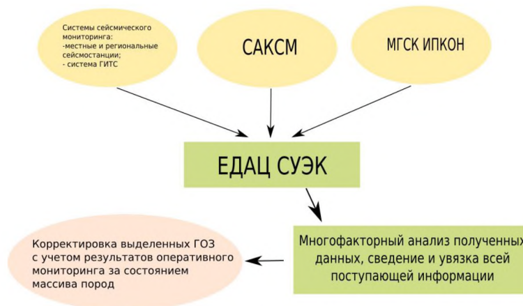
Рис.17. Схема взаимодействия систем оперативного мониторинга за геодинамическим и геомеханическим состоянием массива в составе ЕДАЦ-СУЭК
