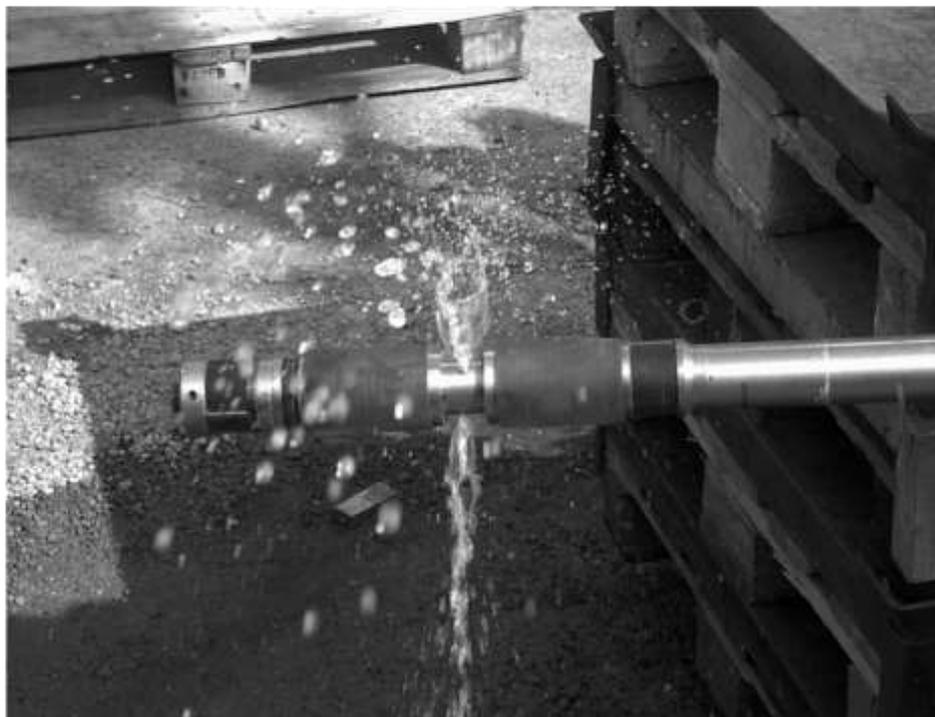
Рисунок 1.11. – Усовершенствованный уравновешенный герметизатор.
