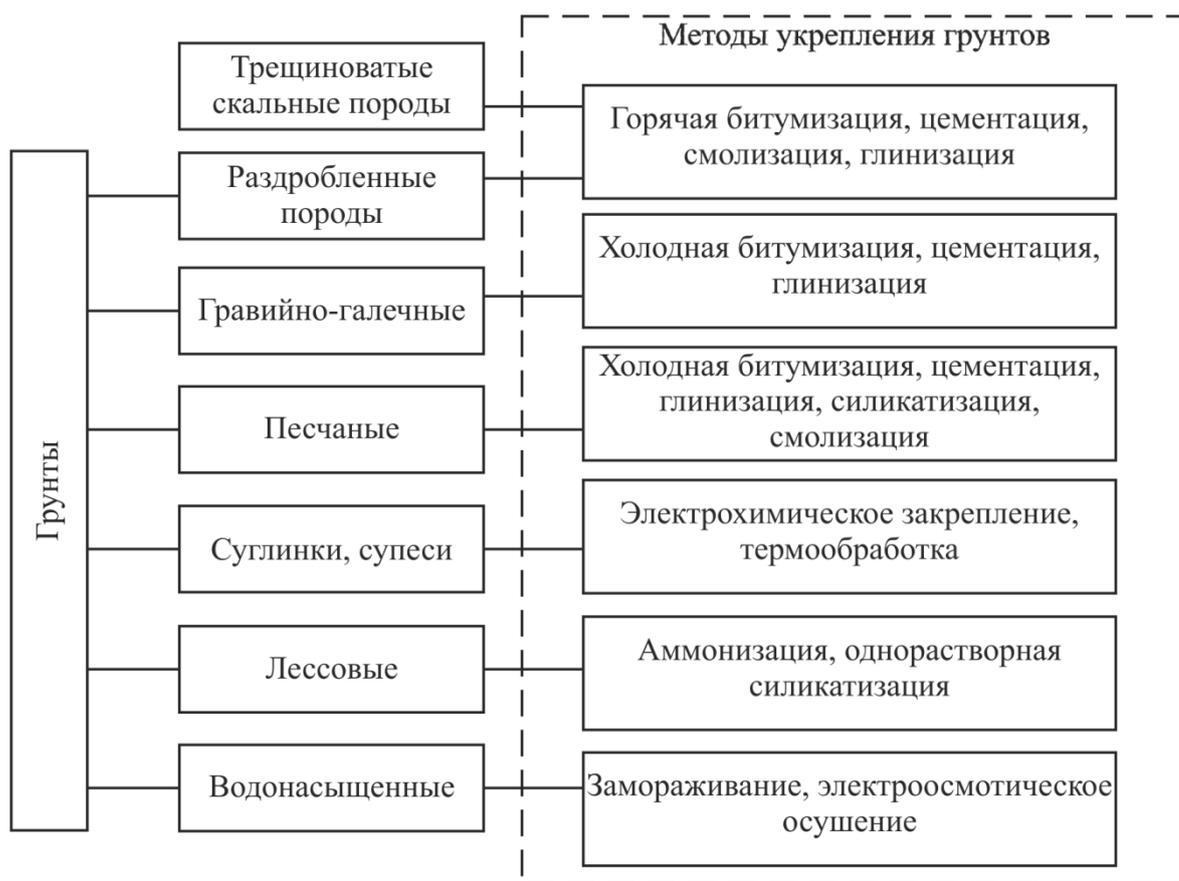
Рис. 1.6. Классификация методов укрепления в зависимости от разновидности грунта основания
