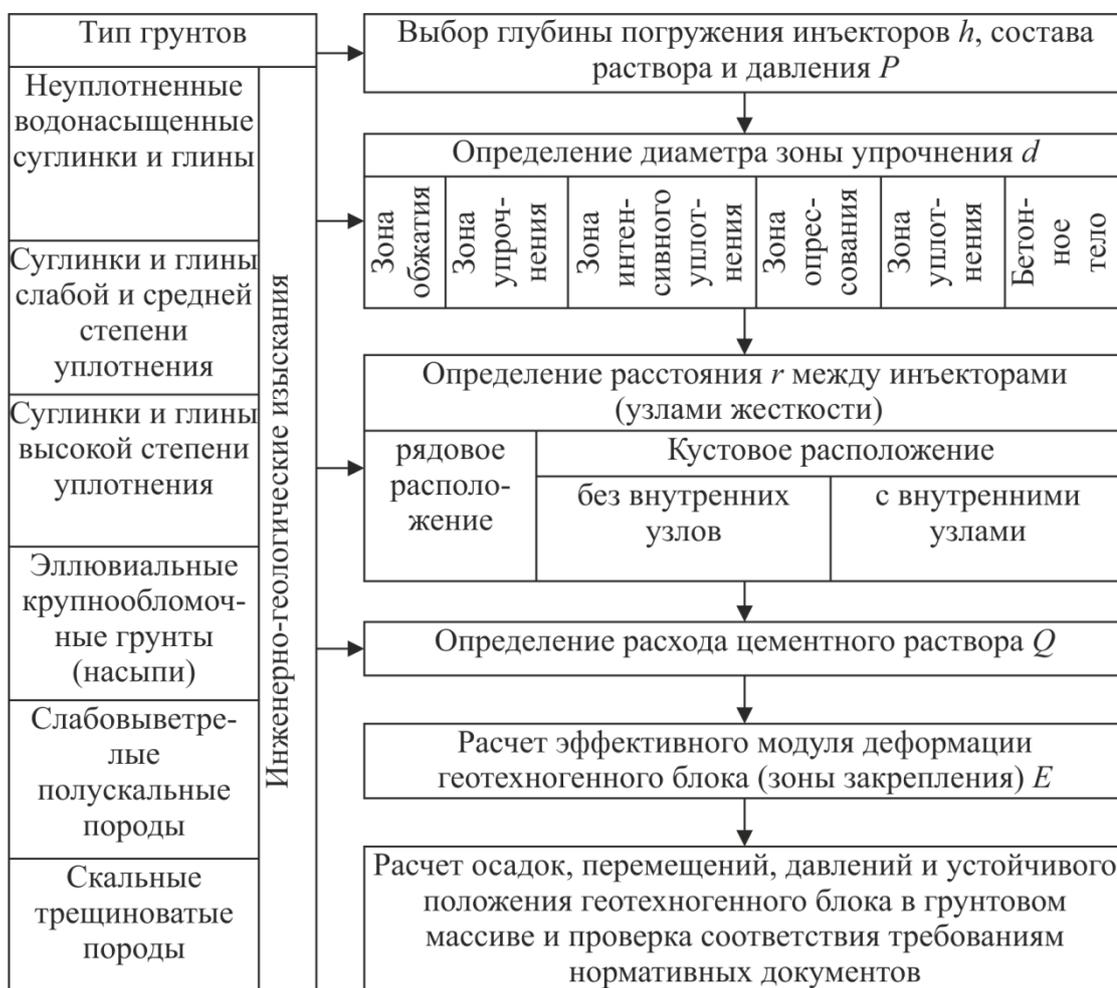
Рис. 4.2. Алгоритм определения технологических параметров укрепления однородного грунтового основания методом геотехногенных блоков (базовой технологией укрепления)
