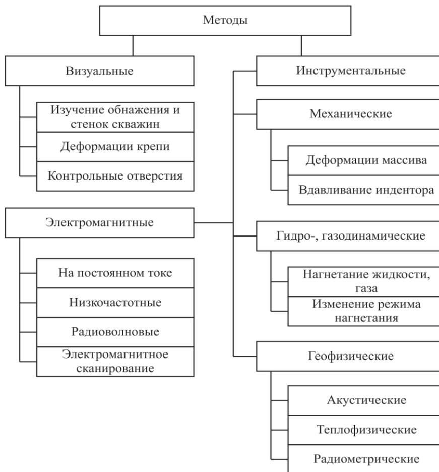
Рис. 1.10. Классификация методов геоконтроля
