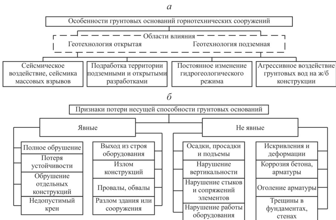
Рис. 1.1. Особенности грунтовых оснований горнотехнических сооружений (*a*) и признаки потери их несущей способности (*б*)
