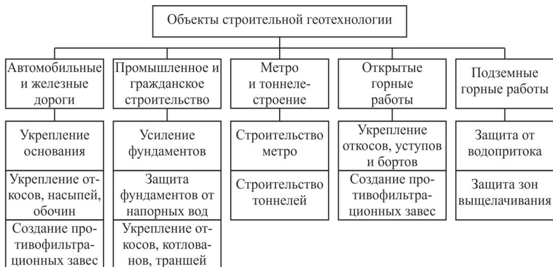
Рис. 1.2. Классификация объектов строительной геотехнологии
