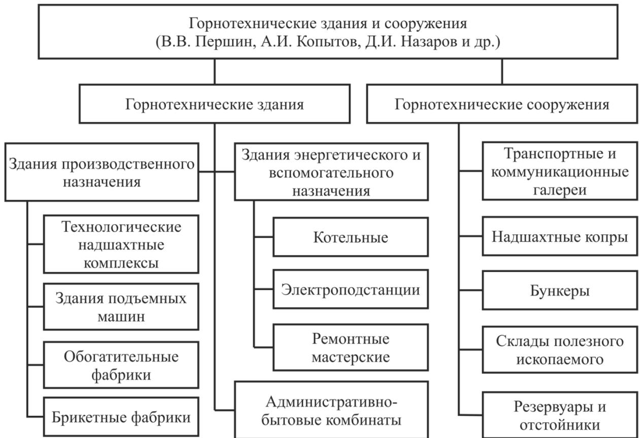
Рис. 1.3. Классификация горнотехнических зданий и сооружений
