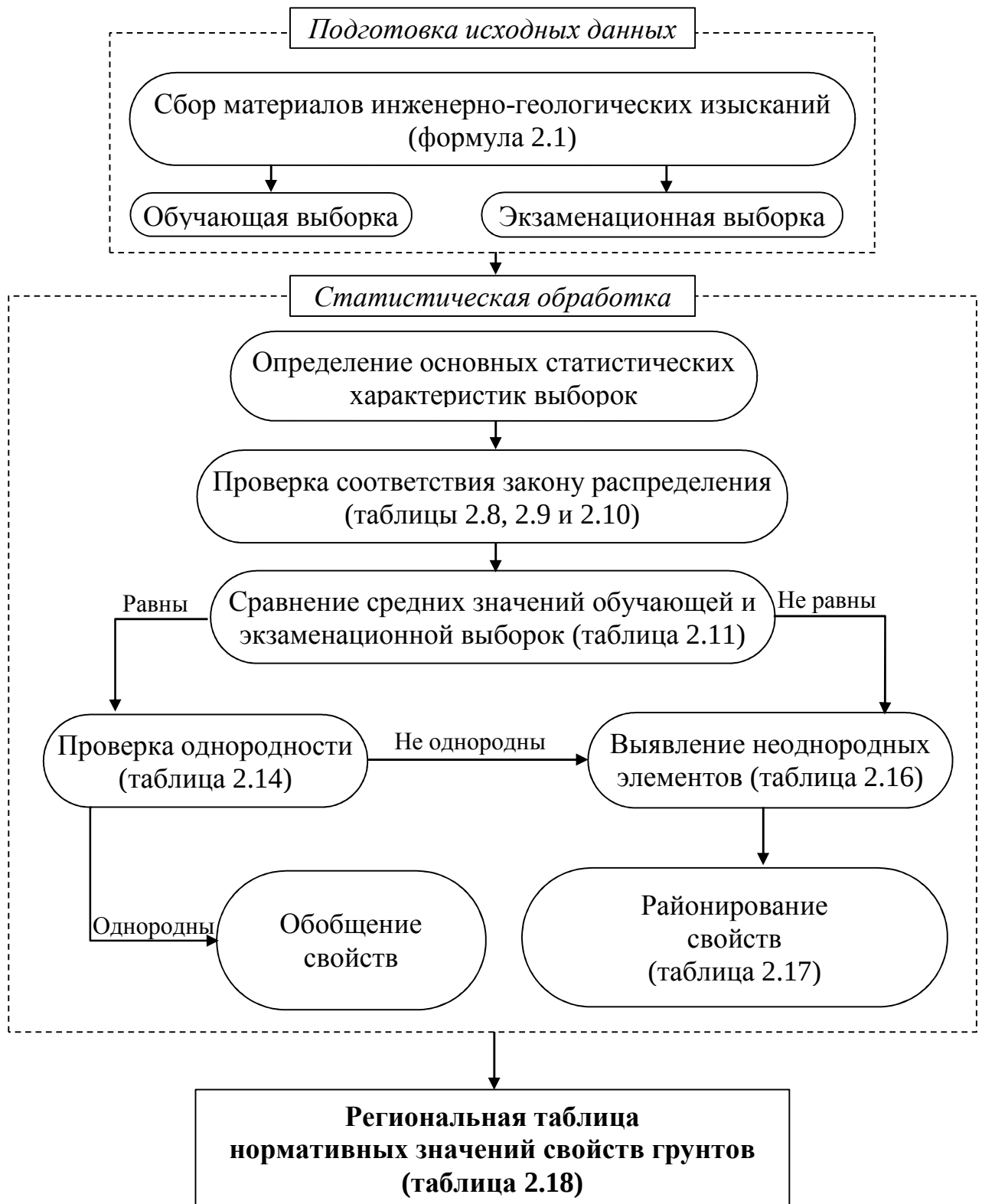
Рисунок 2.8. Структурно-логическая схема анализа и обобщения физико-механических характеристик техногенных грунтов
