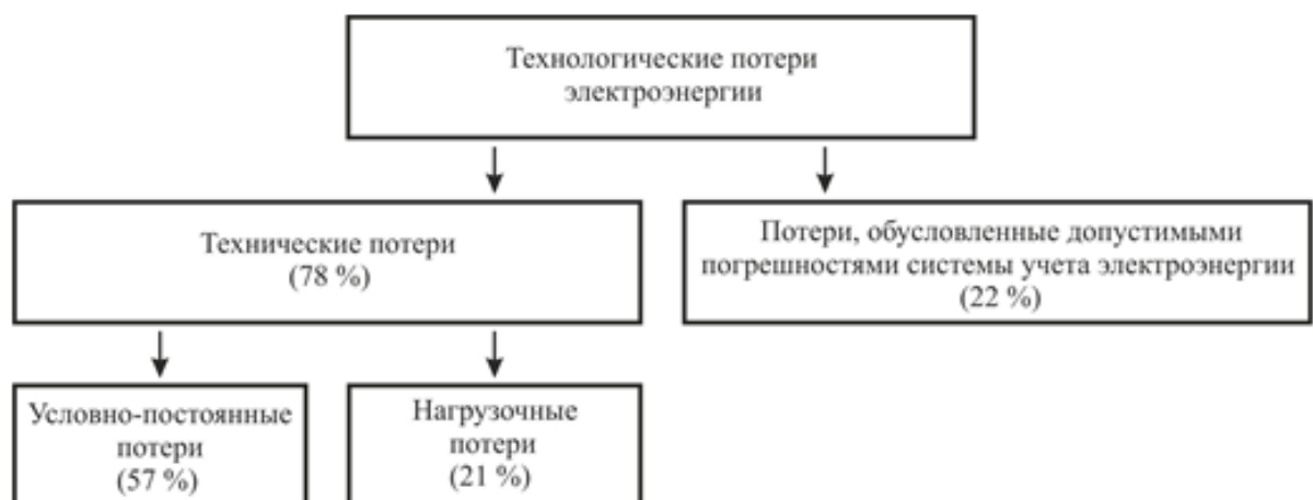
Рисунок 1.5 – Структура технологических потерь электроэнергии при ее передаче по РС ТСО
