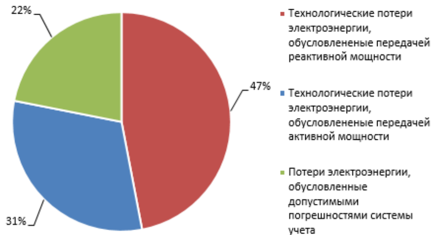
Рисунок 1.8 – Обобщенная структура технологических потерь электроэнергии в РС ТСО
