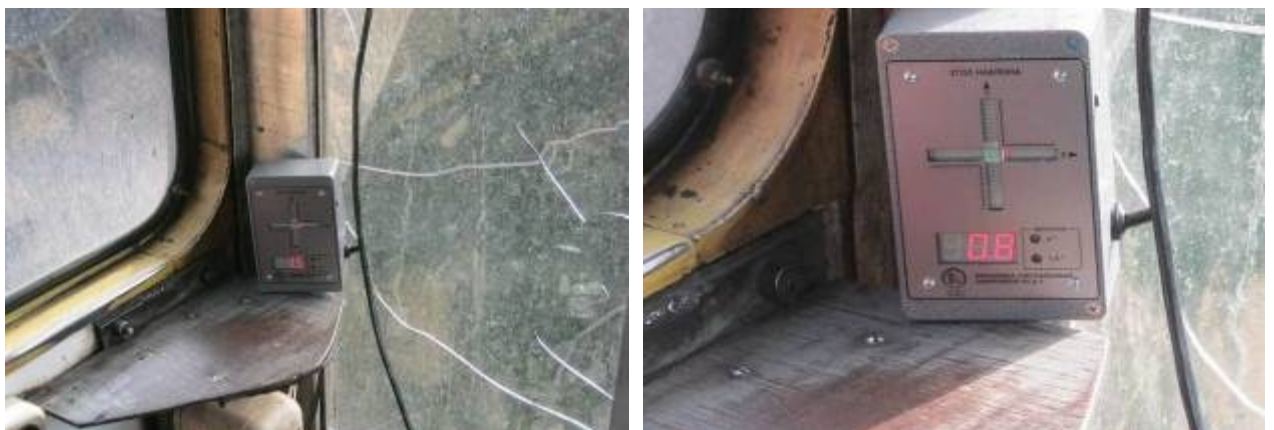
Рисунок 4.2. Установка в кабине блока обработки и индикатора угла наклона для отображения информации и сигнализации
