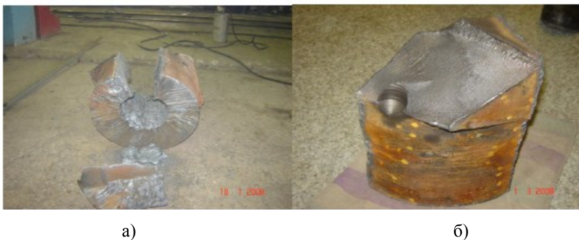
Рисунок 2.8 - Схематичное изображение центральной цапфы и местоположения вырезки контрольного образца
