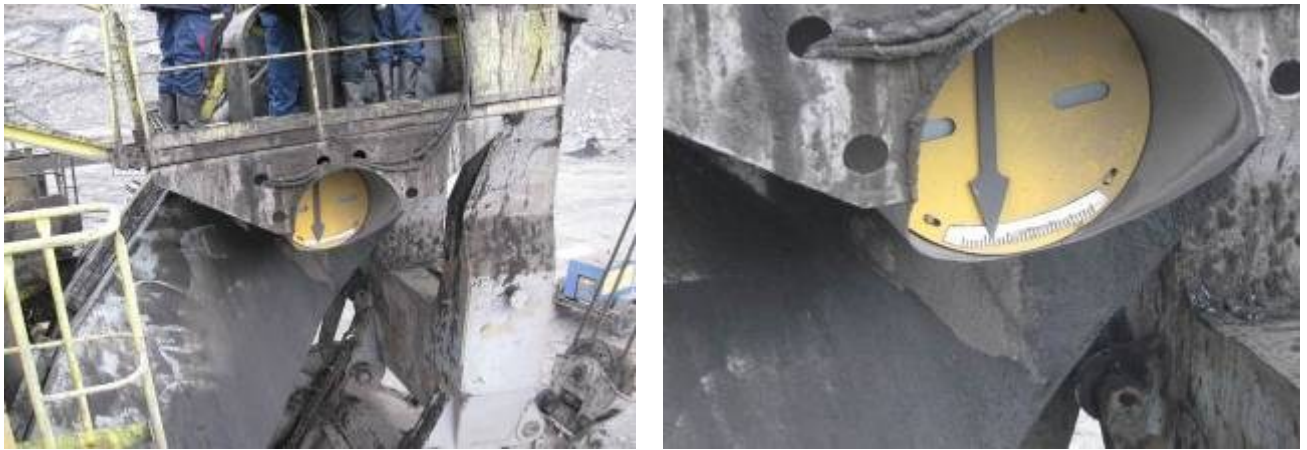
Рисунок 1.18 - Внешний вид указателя продольного наклона ЭКГ-12
