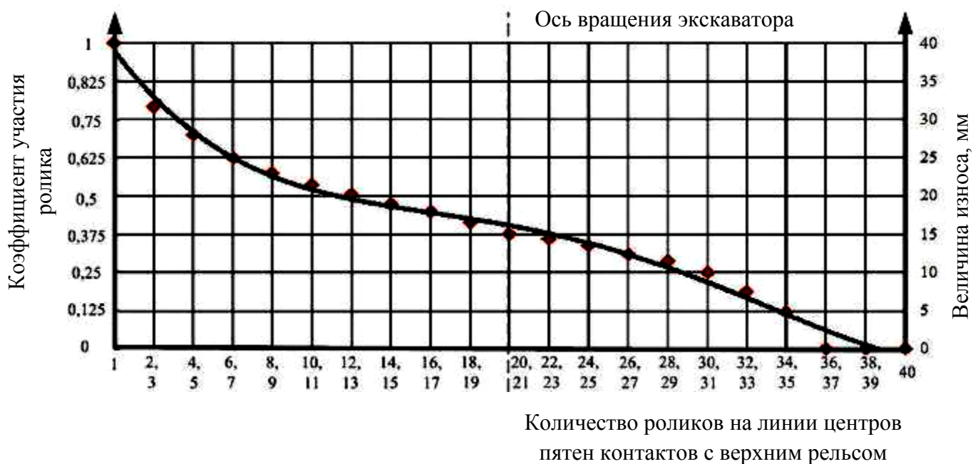
Рисунок 2.4 - Зависимости величины износа верхнего рельса экскаватора ЭКГ-10 от расположения линии центра пятна контакта и коэффициентов участия ролика при восприятии удельной нагрузки
