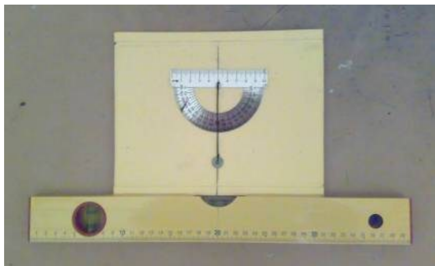
Рисунок 2.12 - Прибор для определения угла наклона экскаватора-мехлопаты на его рабочей площадке
