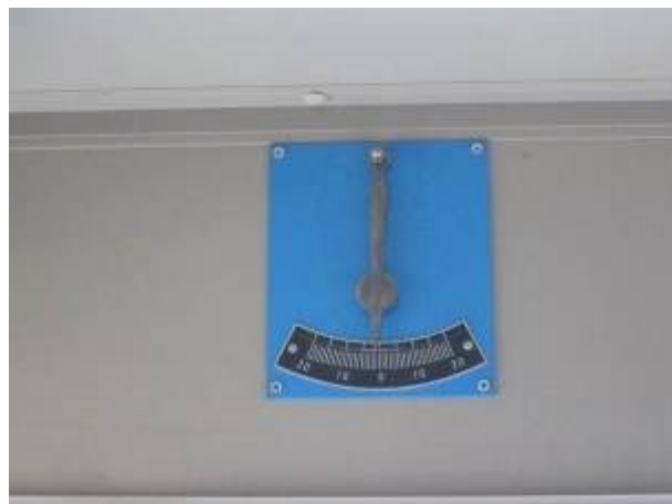
Рисунок 1.16 - Указатель поперечного наклона экскаватора WK-35
