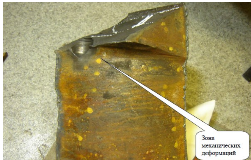
Рисунок 2.11 - Общий вид образца в районе предположительного концентратора
