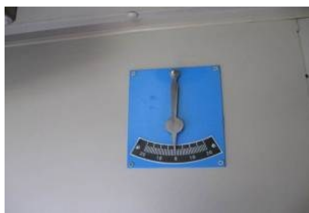
Рисунок 1.17 - Указатель продольного наклона экскаватора WK-35
