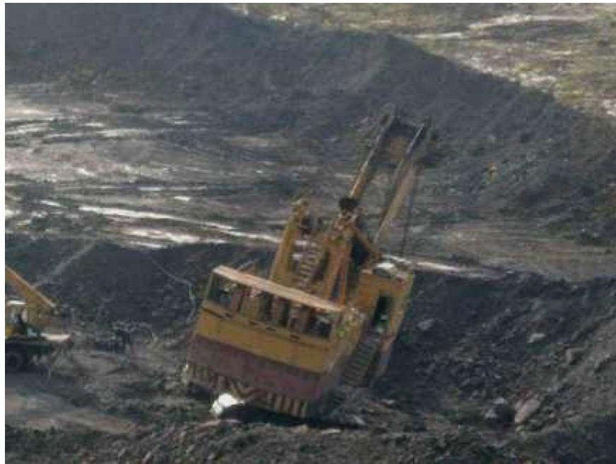
Рисунок 2.17 - Работа экскаватора ЭКГ-10 при наличии просадки грунта рабочей площадки
