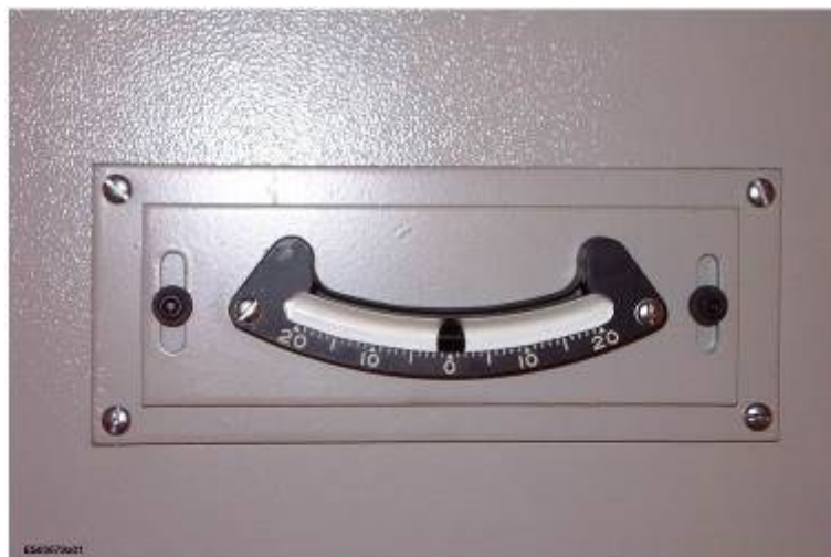
Рисунок 1.15 - Внешний вид поплавкового креномера экскаваторов Р&Н
