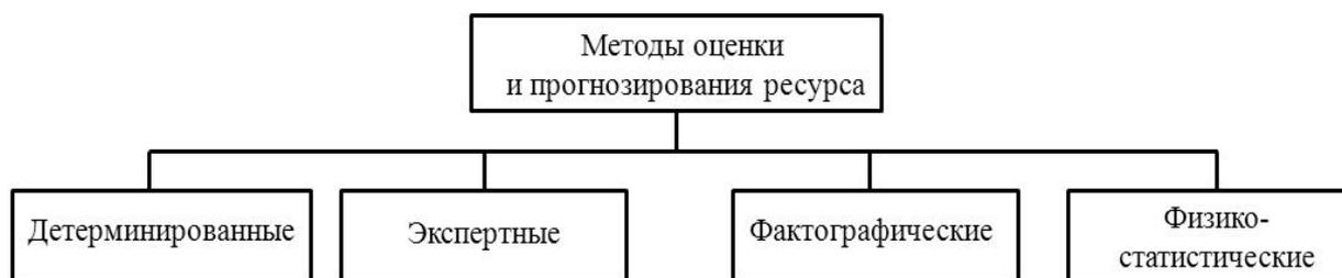
*Рис. 3.1. Классификация методов прогнозирования остаточного ресурса оборудования*
