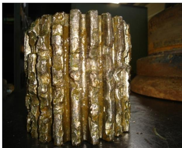
Рис. 4.12. Дефекты зубчатой передачи в волновом редукторе резания комбайна СМ-130К
