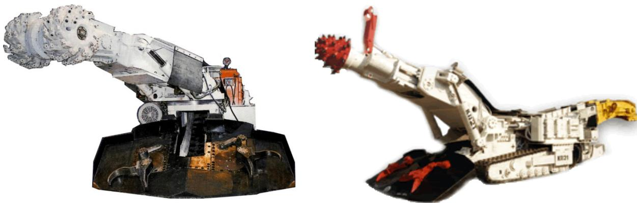
Рис. 1.2. Комбайны с исполнительными органами корончатого типа (избирательного действия)
