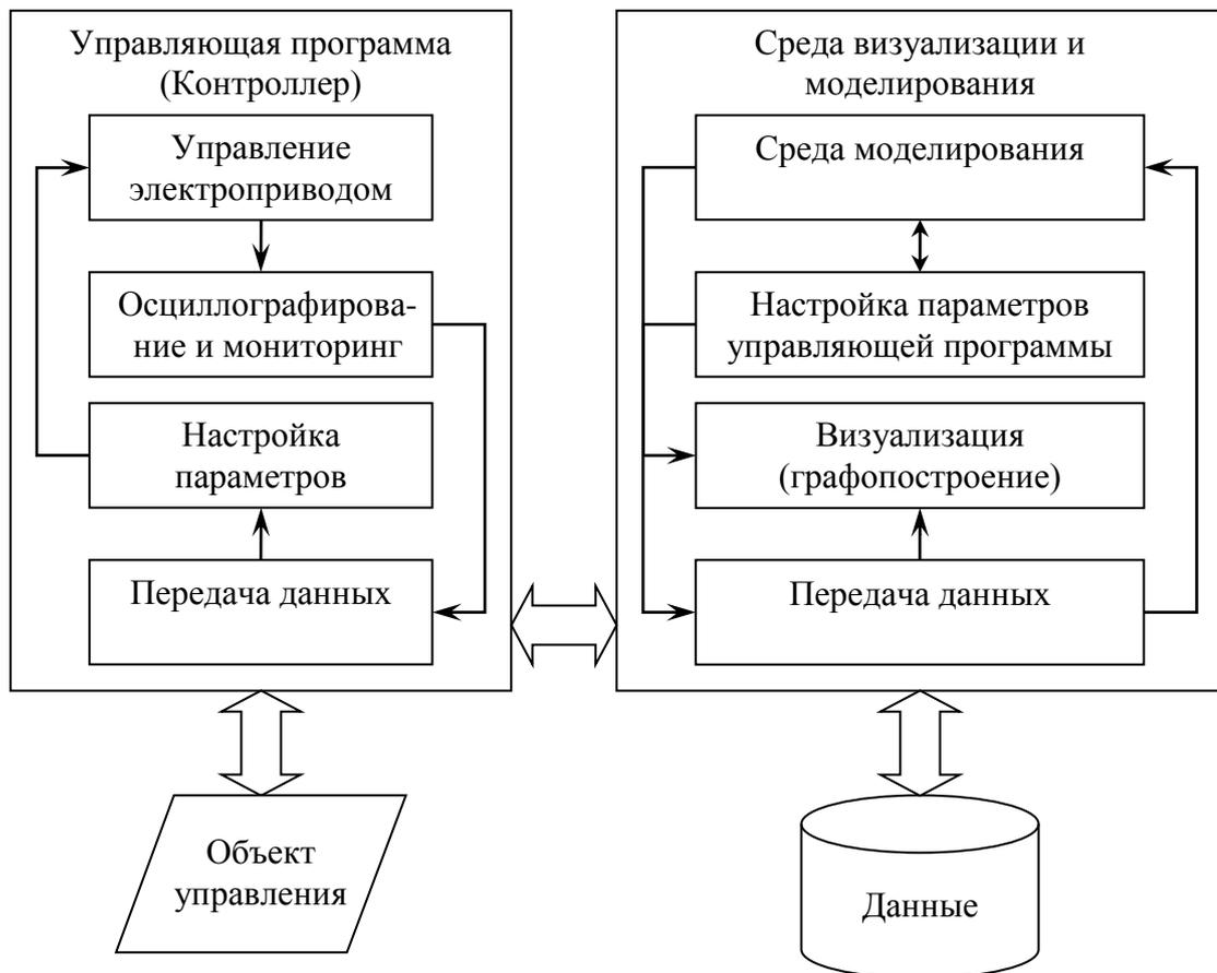
Рисунок 58 – Структурная схема комплекса программ
