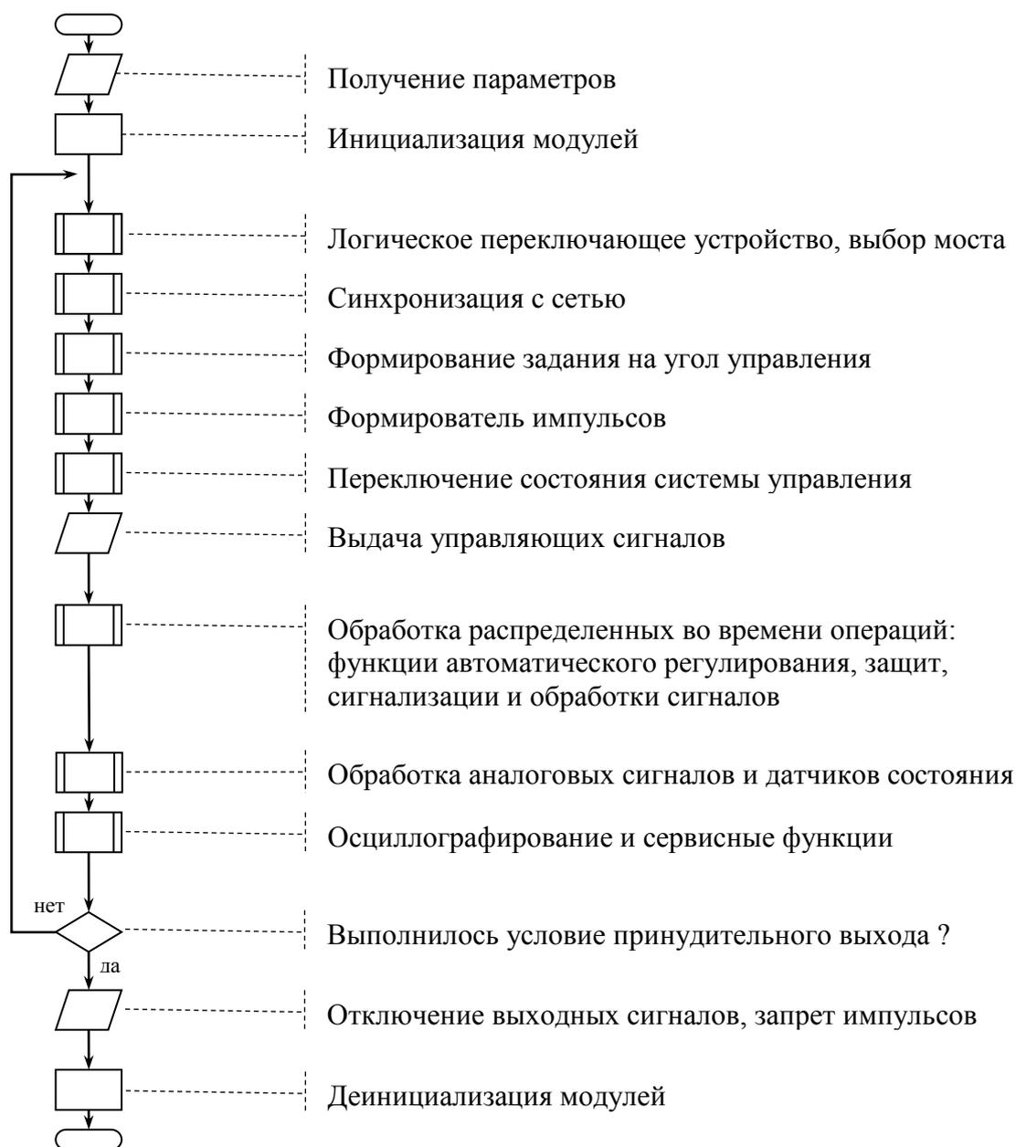
Рисунок 50 – Алгоритм управляющей программы
