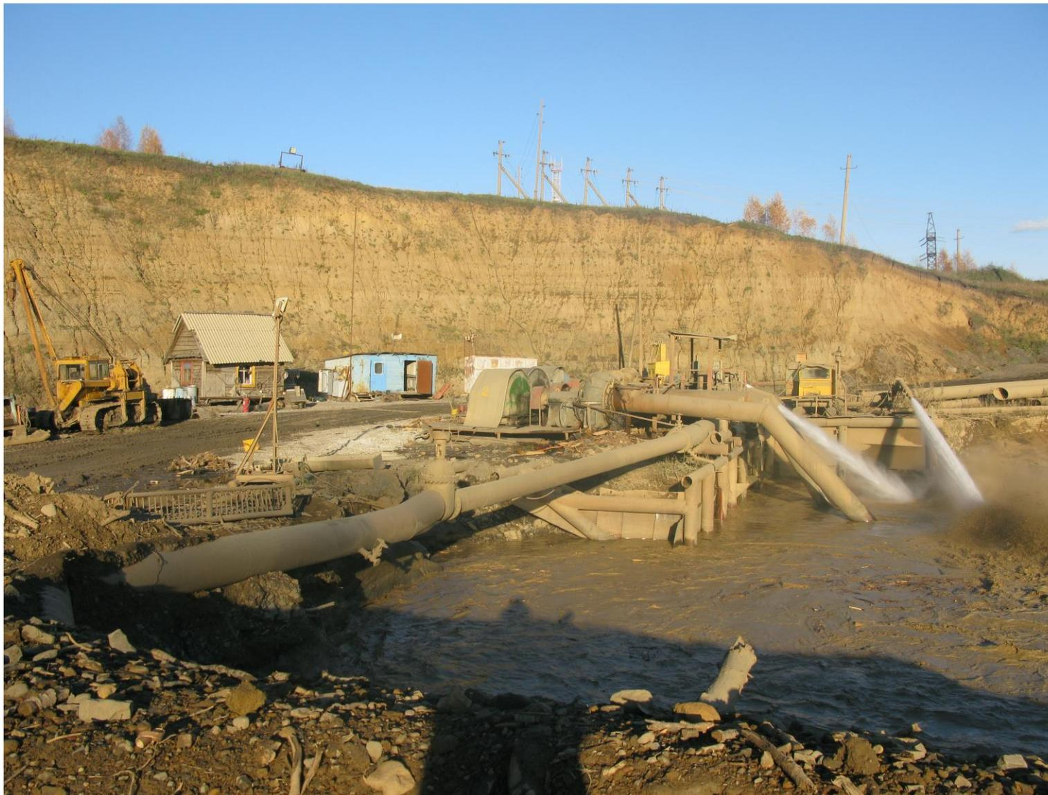
Рис.4.3. Использование зумпфовых гидромониторов ГМД-250М на разрезе «Галдинский»
