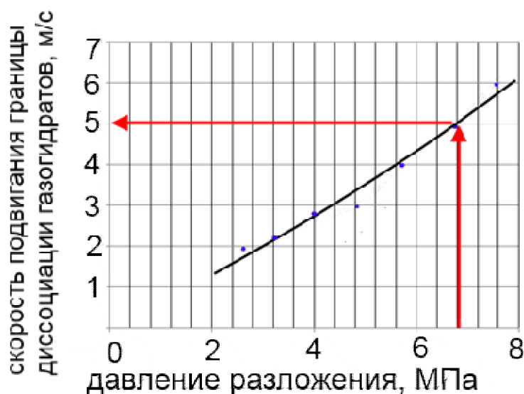
Рис.3.3. Скорость подвигания границы диссоциации ТУГР при различных давлениях разложения
