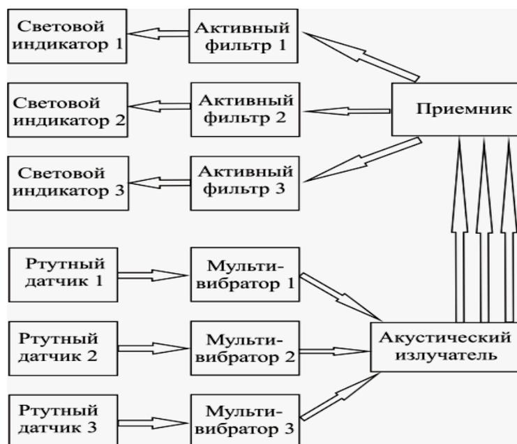
Рисунок 4.14 – Блок-схема устройства для определения направления поворота насадки пневмопробойника с передачей информации на поверхность земли по акустическому каналу связи
