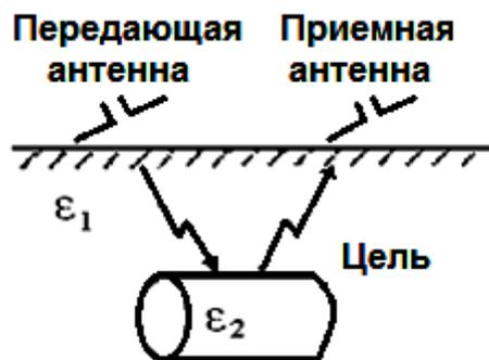
Рисунок 1.7 – К описанию принципа работы георадара:  $\epsilon_1$ ,  $\epsilon_2$  – диэлектрические проницаемости среды распространения электромагнитной волны и «цели» соответственно
