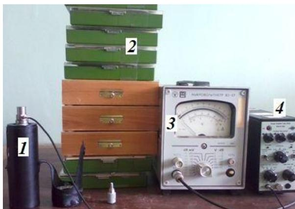
Рисунок Б.2 – Фотография стенда для калибровки акселерометров: 1 – калибратор 4294; 2 – акселерометры KD29; 3 – милливольтметр ВЗ-57; 4 – усилитель 2635
