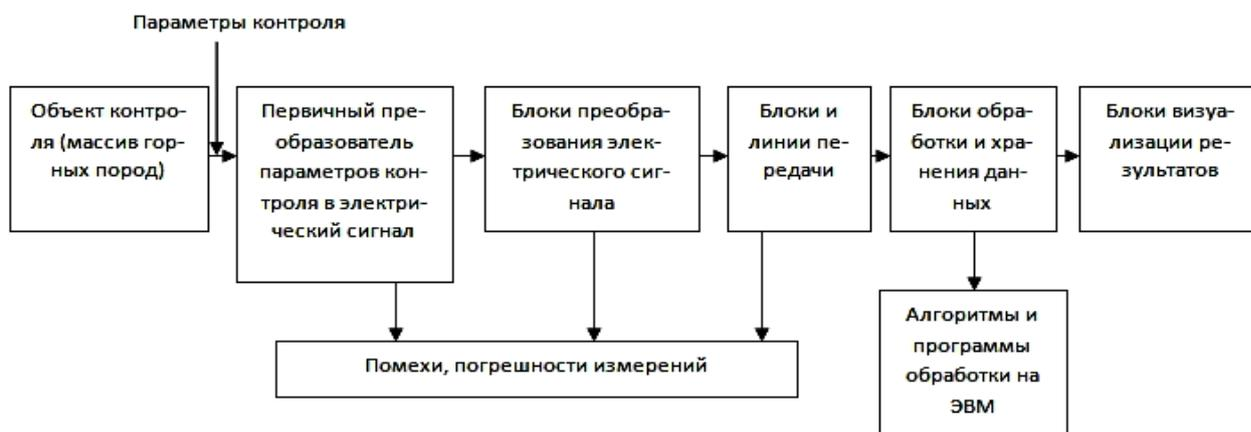
Рисунок 1.12 – Типовая структурная схема для инструментального контроля геомеханических процессов в породном массиве [81]
