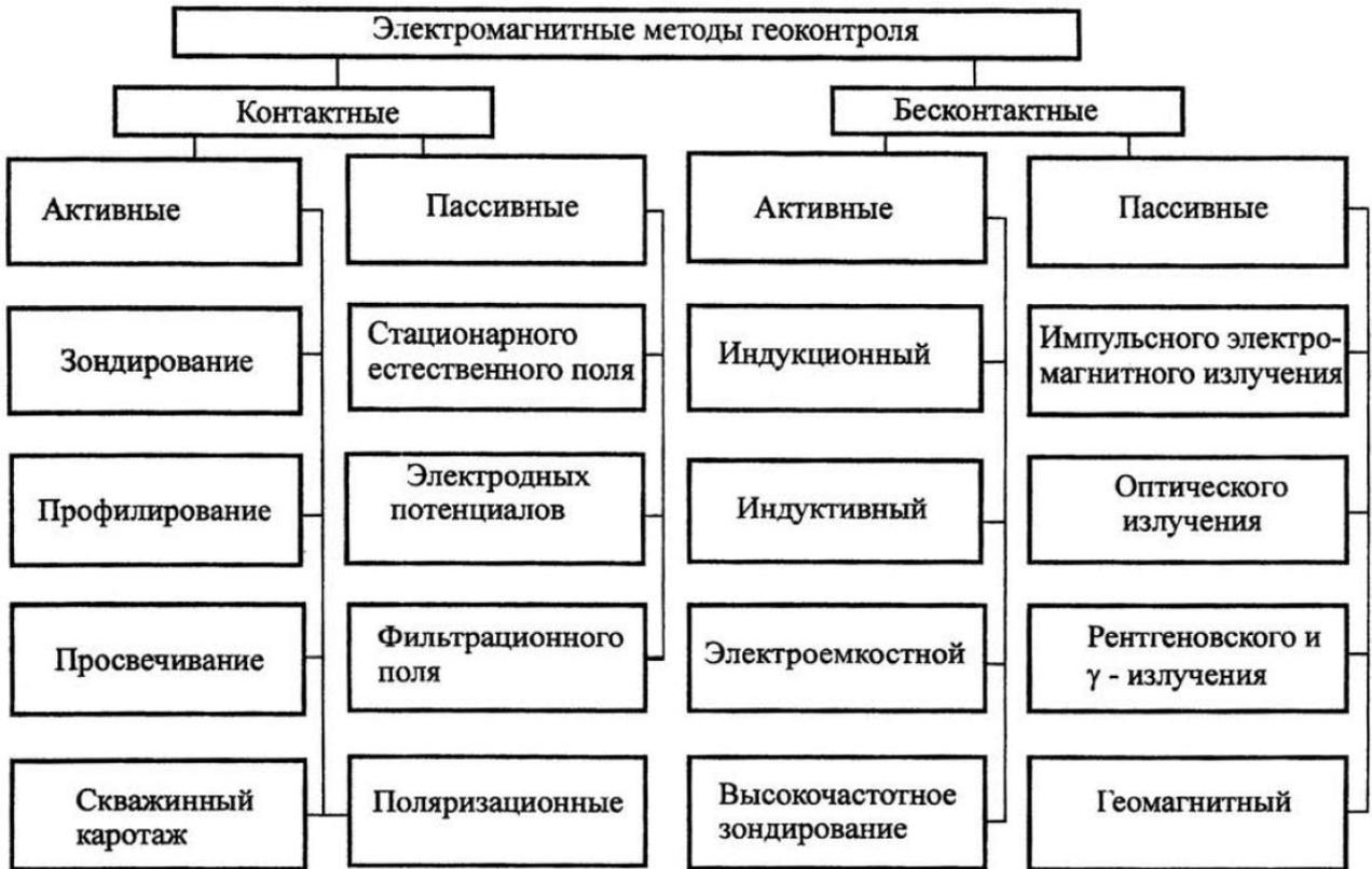
Рисунок 1.5 – Классификация геофизических методов геоконтроля
