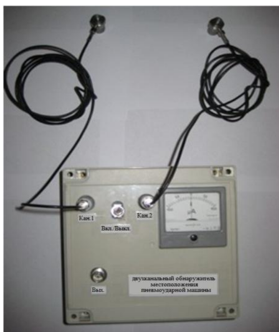
Рис. 11. Двухканальный обнаружитель местоположения пневмоударной машины: а – опытный образец, б – испытания в натуральных условиях
