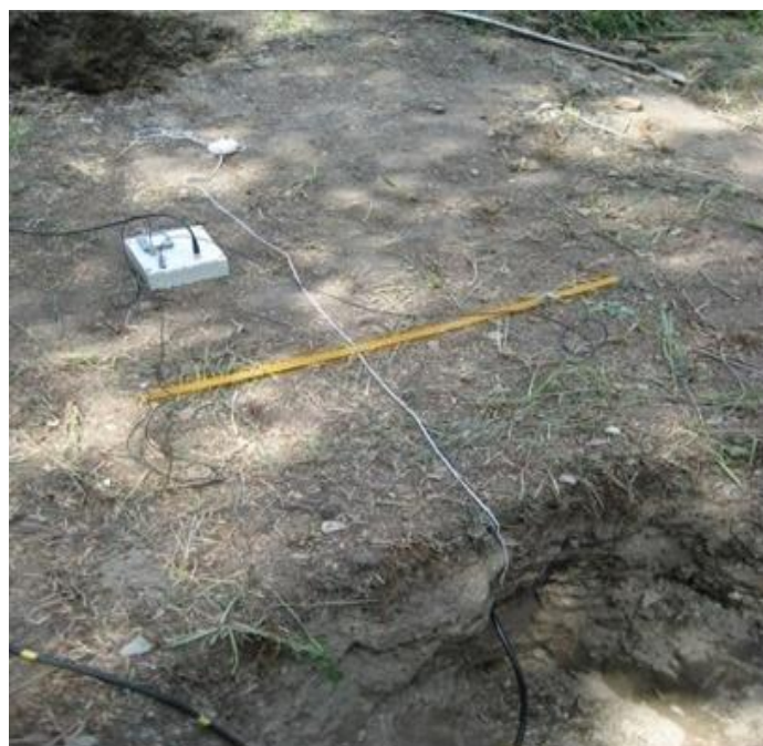
Рис. 11. Двухканальный обнаружитель местоположения пневмоударной машины: а – опытный образец, б – испытания в натуральных условиях
