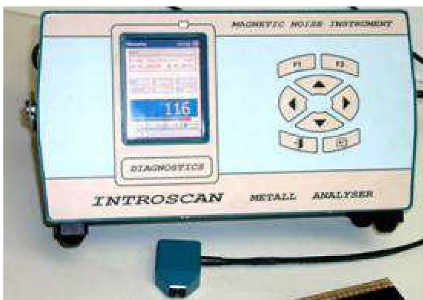
Рис. 2.3. Анализатор магнито-шумовой Интроскан
