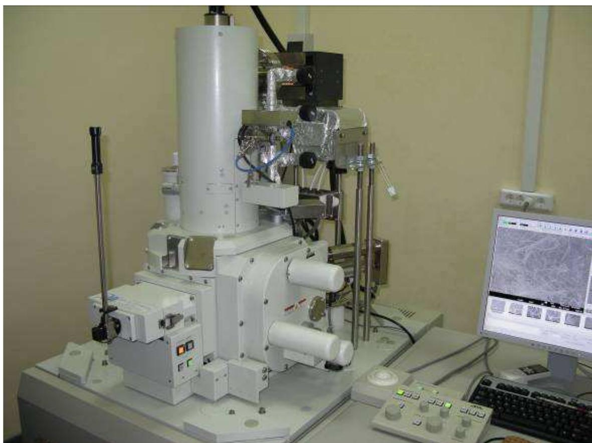
Рис. 1.7. Сканирующий электронный микроскоп JEOL JSM-7500FA
