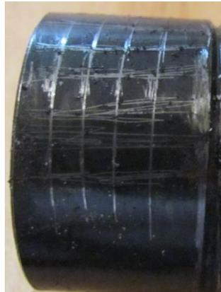
Рисунок 4. Фотография сетки царапин покрытия
