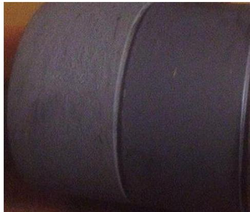
Рисунок 1. Фотография покрытия на основе фенолформальдегидной смолы с графитом и дисульфид молибденом
