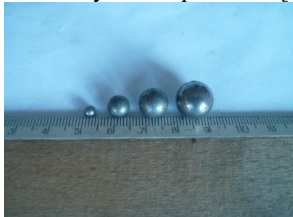
Рис. 2. Рабочая среда - шары из стали ШХ 15:
