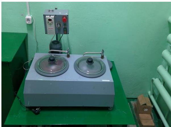
Рисунок 3. Шлифовально - полировальный станок мод. ШЛИФ – 2 М/У
