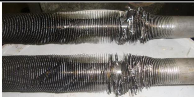
Рисунок 2 – Бракованная ребристая труба
