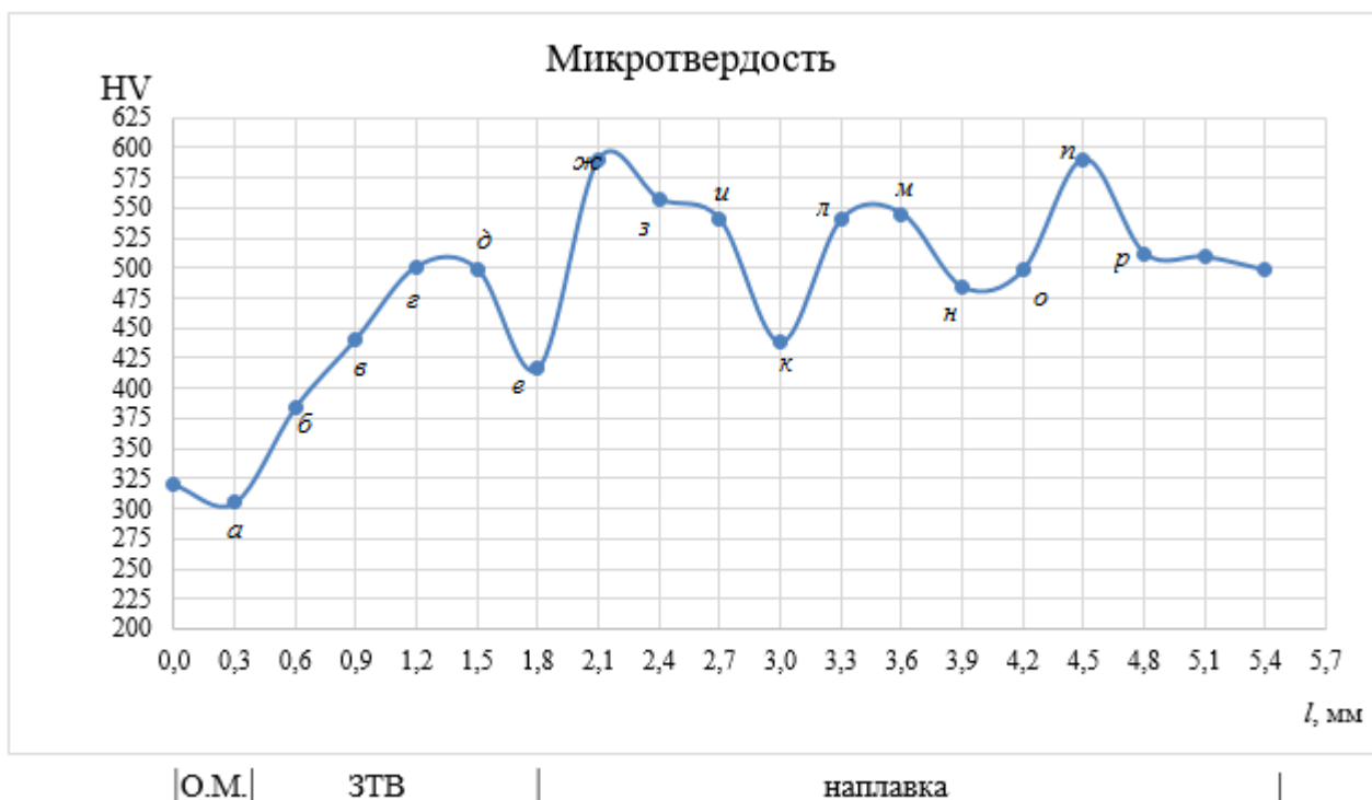
Рис. 1. Зависимость микротвердости наплавленного слоя и зоны термического влияния детали ось от глубины проведения измерений
