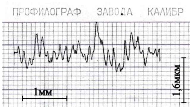
Рис.4. Профилограмма поверхности образца из стали 45 после ультразвуковой обработки
