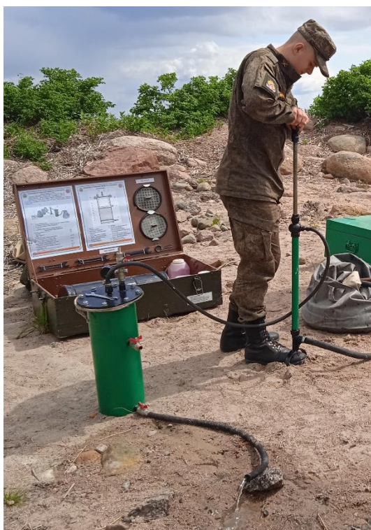
Рис. 4. Работа на усовершенствованном фильтре ТУФ-200 с шаровыми кранами
