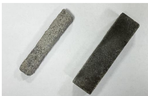
Рис. 1а (слева). Изменение массы образцов с течением времени. Рис. 1б (справа). Внешний вид образцов в конце срока наблюдений: образец слева – из кислотной среды, справа – из воды
