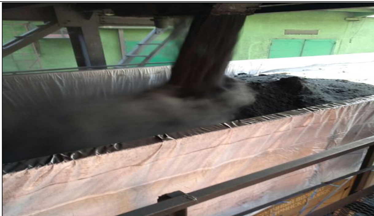
Рисунок 1 – Процесс выделения уловленной коксовой пыли при загрузке в железнодорожные полувагоны
