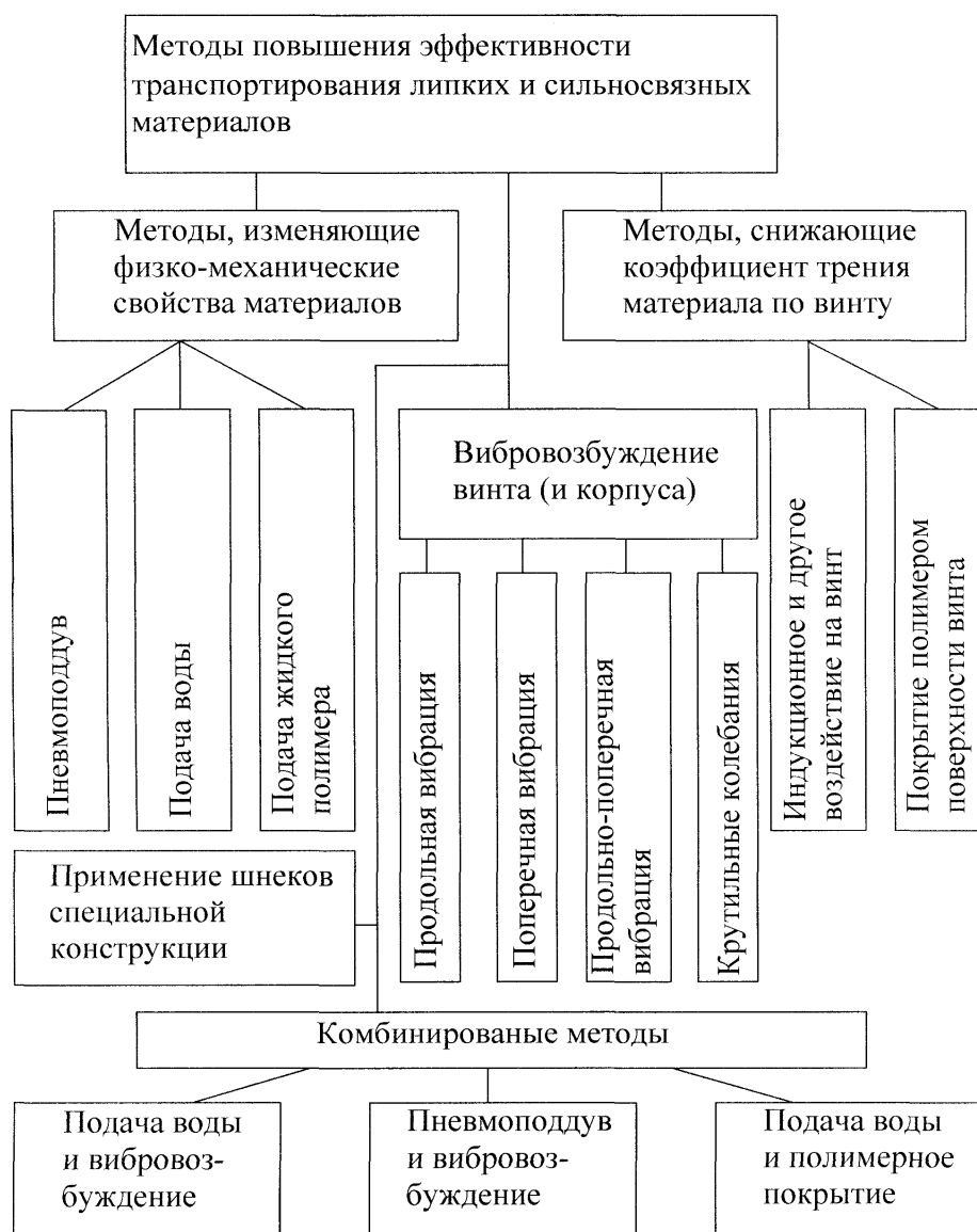
Рис. 1. Классификация методов повышения эффективности транспортирования липких и высокопрочных материалов
