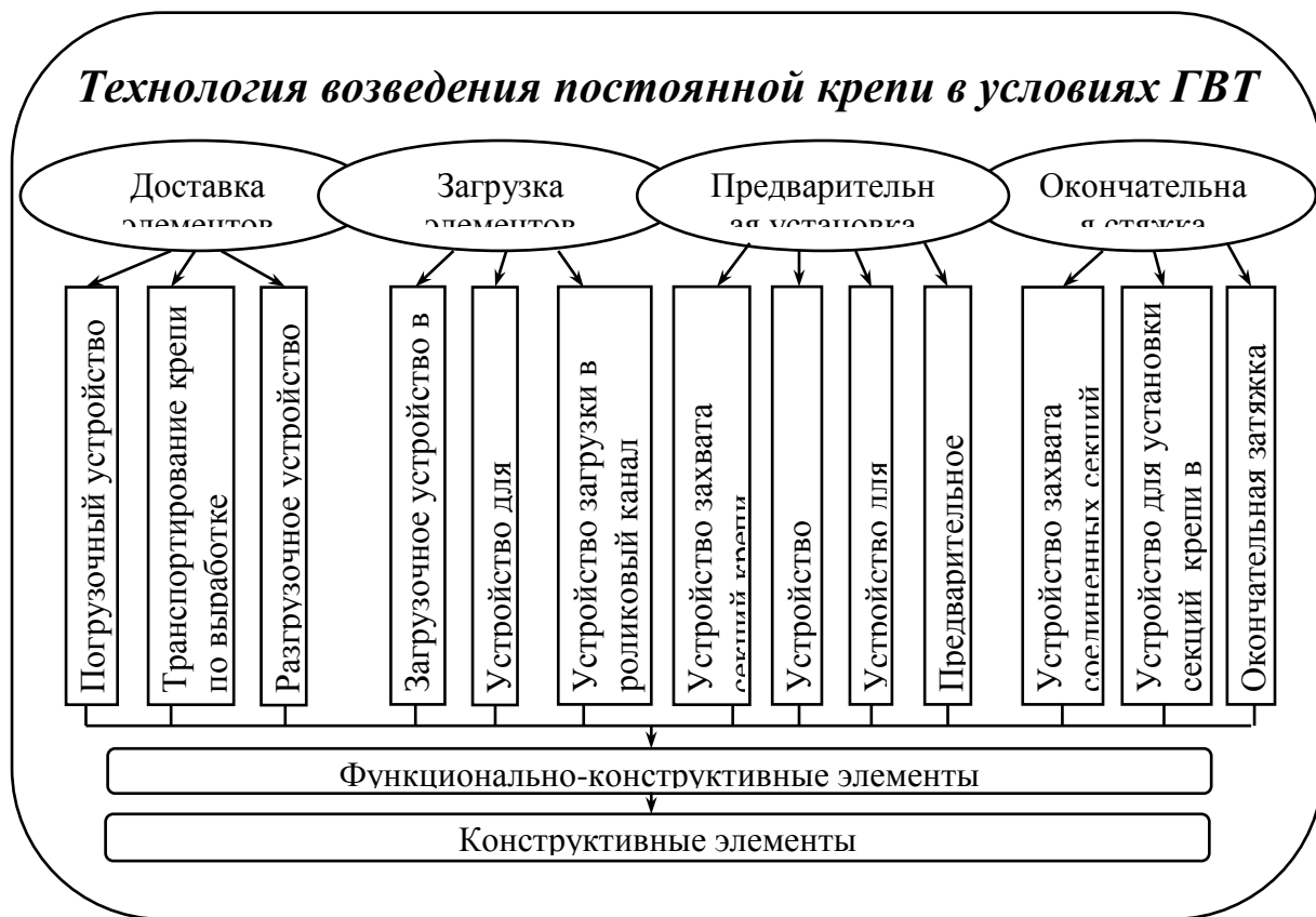
Рисунок 2 Схема технологии возведения постоянной крепи
