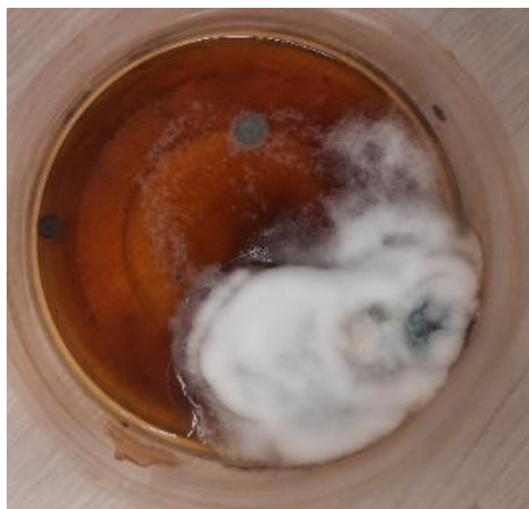
Рисунок 1. Образование плесени на образце с крахмалом
