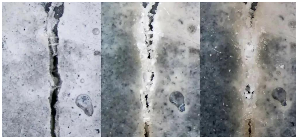
Рисунок 1. Процесс восстановления трещины биобетона
