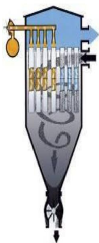
Рисунок 2. Рукавный фильтр в разрезе [2]
