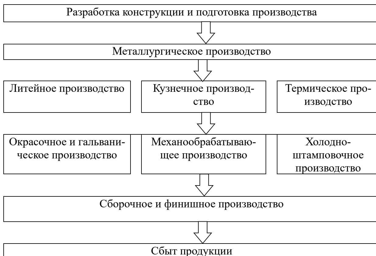
Рисунок 2. Схема производственного процесса изготовления тракторов
