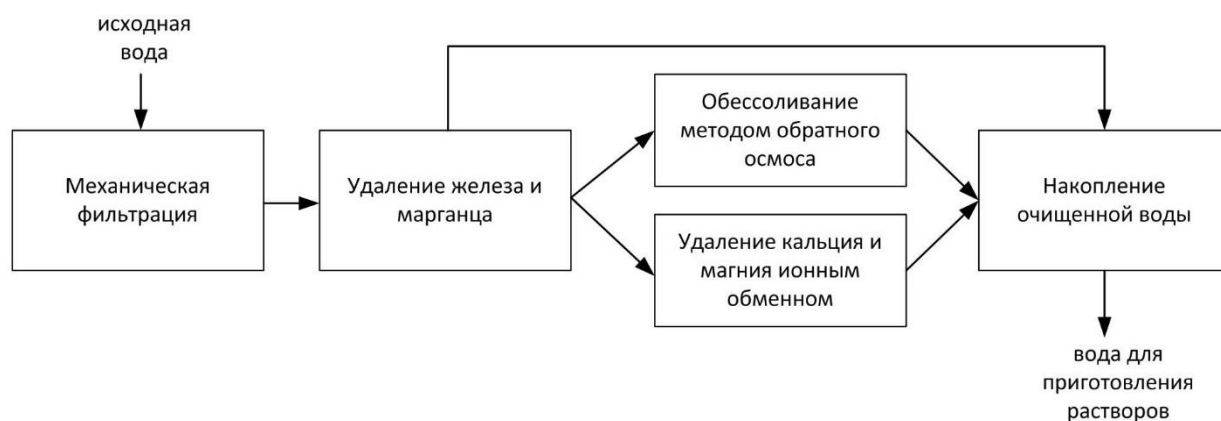
Рисунок 2 – Блок-схема очистки подземной воды для приготовления растворов
