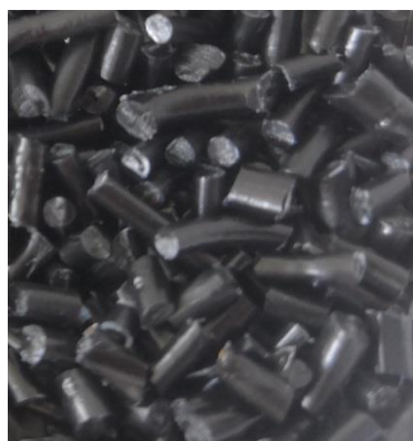
Рис. 2. Общий вид экструдата, наполненного УТО
