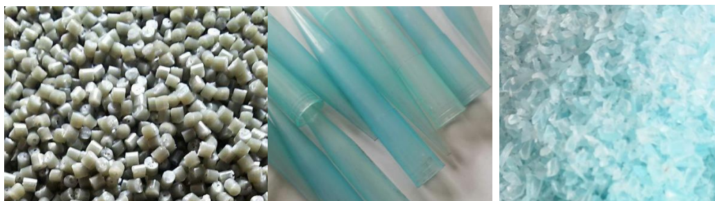
Рис. 1. Общий вид: а – гранулы ВПЭ; б – изделия до измельчения; в – изделия после измельчения («дроблёрка»)
