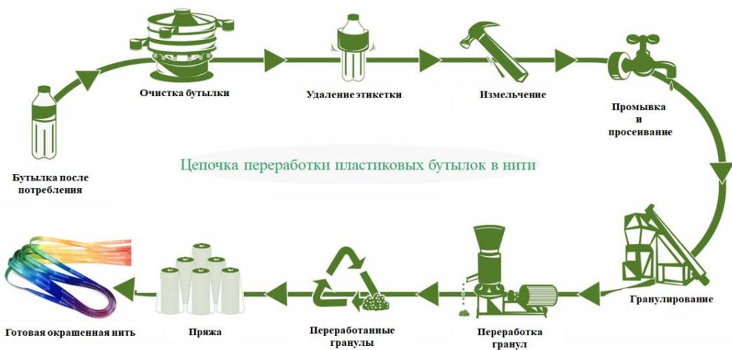
Рис.1. Цепочка переработки пластиковых бутылок в нити [6].
