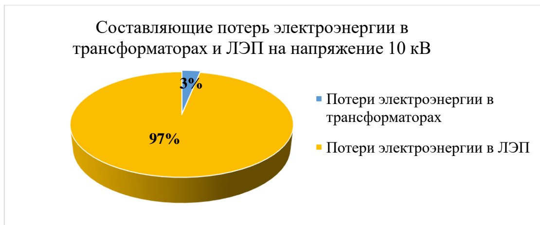
Рисунок 3. Составляющие потерь электроэнергии в трансформаторах 10/0,4 кВ и ЛЭП-10
