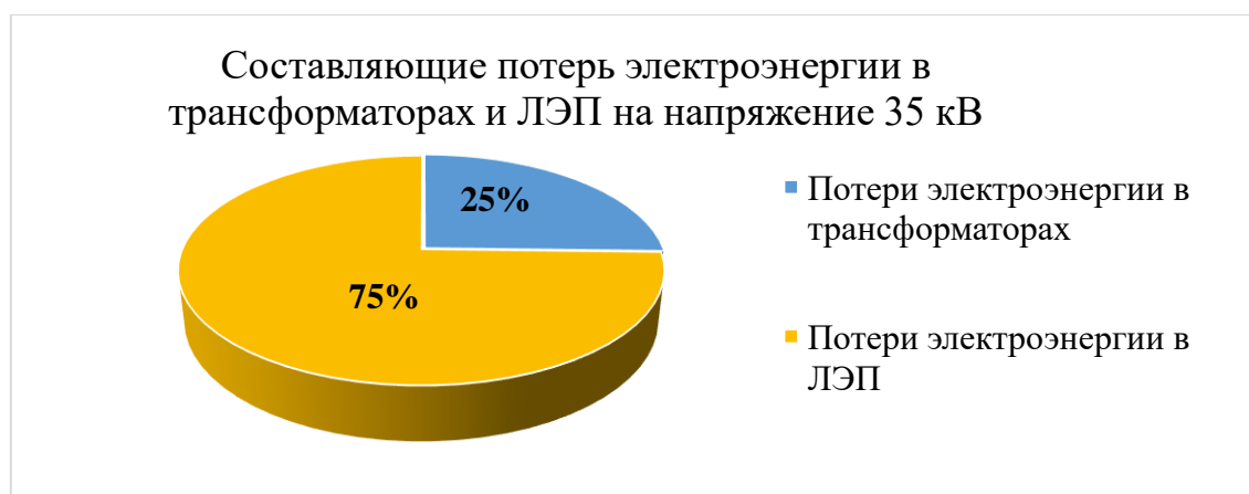
Рисунок 2. Составляющие потерь электроэнергии в трансформаторах 35/0,4 кВ и ЛЭП-35
