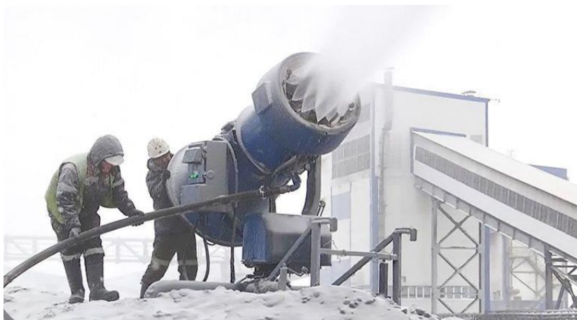
Рисунок 3 – Снежная пушка Hedco standard snowmaker 22 SCNT
