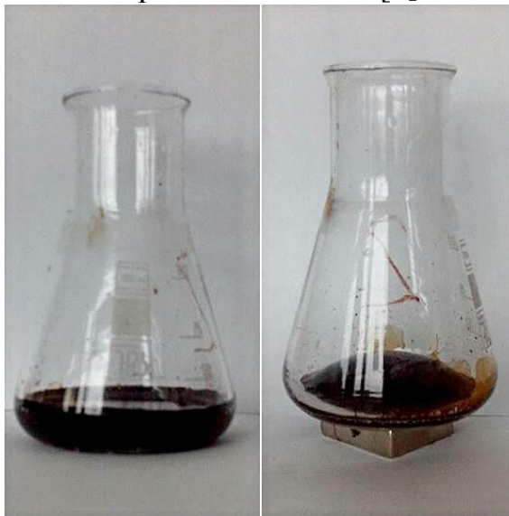
Рис. 1. Слева образец магнитной жидкости без действия магнитного поля, справа – под действием магнитного поля
