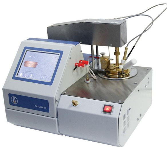
Рисунок 1 – Общий вид прибора ТВЗ-ЛАБ-12 для контроля температуры вспышки масла
