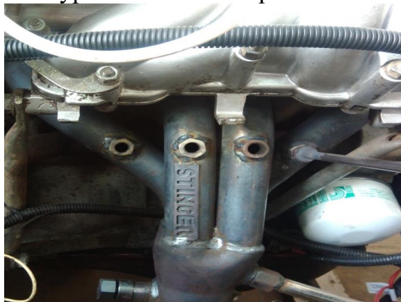
Рисунок 1 – Выпускной коллектор системы выпуска отработавших газов с точками присоединения заборного зонда газоанализатора
