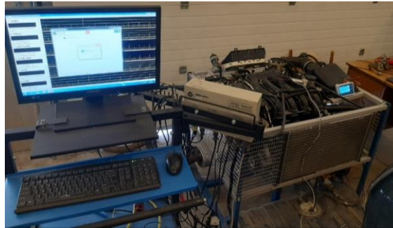
Рисунок 1 – Общий вид диагностического оборудования, установленного на испытательном стенде двигателя ВАЗ-2115
