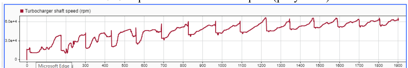
Рисунок 2 – Зависимость частоты вращения вала ротора ТКР (Turboshaft speed (rpm)), мин -1 двигателя автомобиля КАМАЗ 740 Евро-4 при ступенчатом тренде его нагружения
